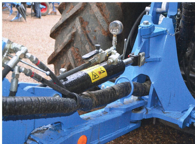
Les améliorateurs de traction transfèrent une partie du poids de la charrue semi-portée vers l'essieu arrière du tracteur. Photo : Ruedi Hunger
