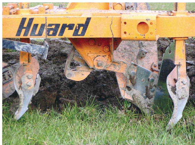
La sécurité «semi-automatique» se place entre la sécurité par boulon de cisaillement et les systèmes non-stop. Photo : Ruedi Hunger
