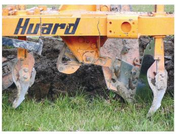
La sécurité «semi-automatique» se place entre la sécurité par boulon de cisaillement et les systèmes non-stop. Photo: Ruedi Hunger
