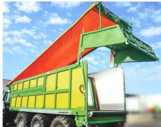
l'arrière déplacent l'enrouleur de gauche à droite et inversement lors de la fermeture. Ce système étanche à l'eau permet d'ouvrir la trappe arrière sans débâcher.
