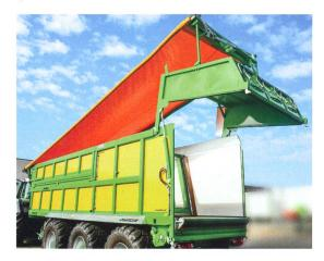
l'arrière déplacent l'enrouleur de gauche à droite et inversement lors de la fermeture. Ce système étanche à l'eau permet d'ouvrir la trappe arrière sans débâcher.
