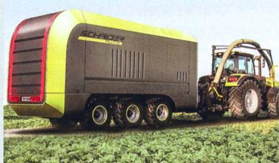
masse à 70 °C avant la phase de pressage proprement dite qui la transforme en pellets tout prêts. Un tamis sépare la poussière des pellets. La trémie et le convoyeur de déchargement servent à stocker et refroidir les granulés terminés, prêts à l'usage.
