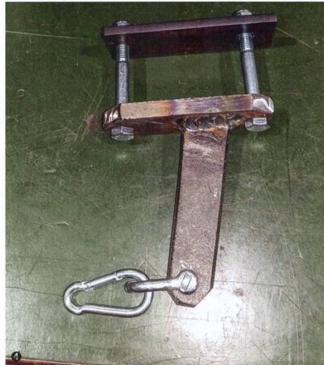
**❶ Les installations de liaison de sécurité selon UNECE-R 55 doivent être équipées d'un anneau pour la fixation de la ligne de liaison.** Photos: Hirschi AG, Bienna, Magnus Gwerder, Muotathal, Nadja Vogelsang
