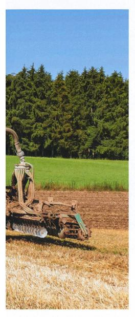
Lorsque transport et distribution se font séparément, la pression des pneus de chaque véhicule peut être idéalement réglée selon le travail à accomplir. Photo: Zunhammer
