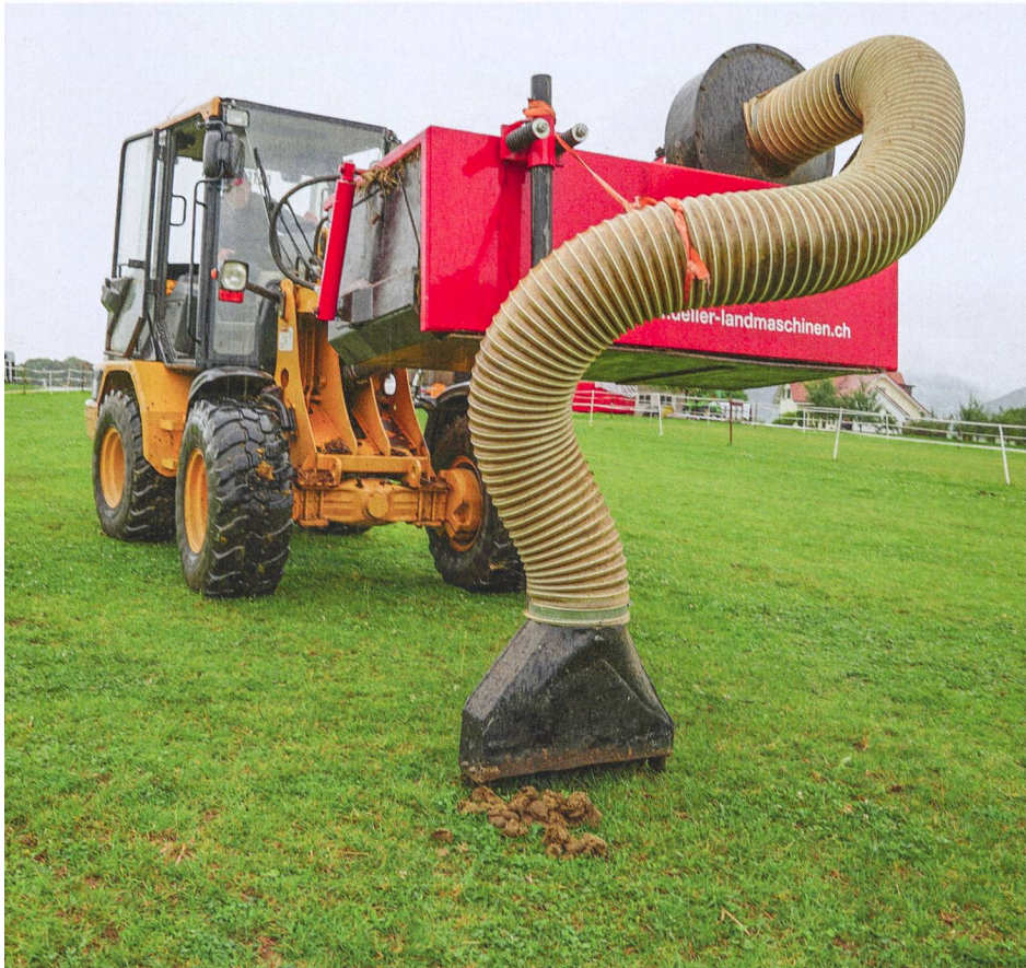
Le prototype d'un collecteur de fumier de cheval est testé chez l'éleveur Huber à Wenslingen (BL). Photos : Dominik Senn :
