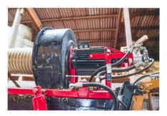
L'électromoteur tournant au ralenti sert uniquement de palier entre le ventilateur d'aspiration et le moteur hydraulique.
