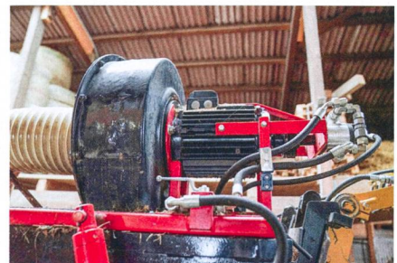
L'électromoteur tournant au ralenti sert uniquement de palier entre le ventilateur d'aspiration et le moteur hydraulique.
