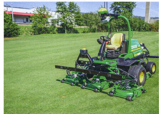
Une tondeuse John Deere « 9009 » sans pilote se déplace de manière autonome sur le green et les fairways.
