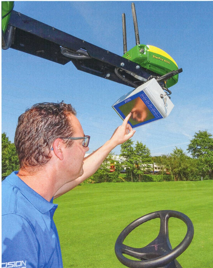
Les principaux éléments intervenant dans le déplacement autonome : le récepteur GPS et l'électronique de pilotage.
