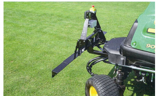
Les « pare-chocs » sont bourrés de capteurs radars et ultrasons, grâce auxquels la tondeuse reconnaît son environnement et est en mesure de réagir aux obstacles (en les contournant ou en s'arrêtant).
