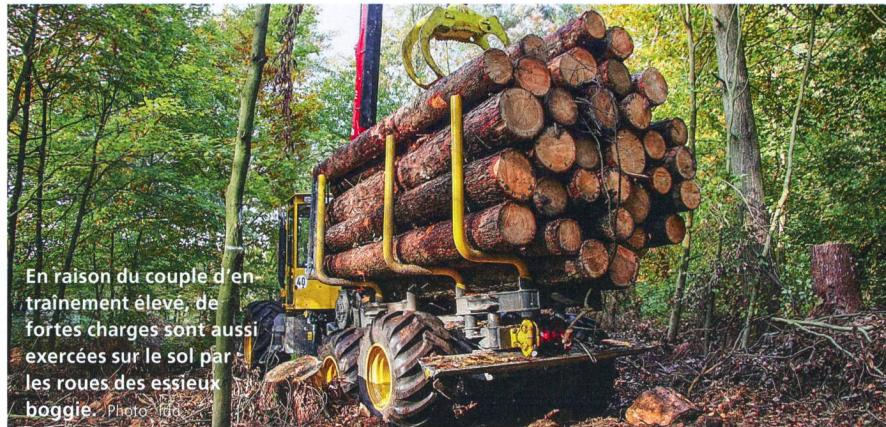
La répartition de charge la plus uniforme possible sur toutes les roues constitue un critère important pour assurer la durabilité des layons de débardage et des chemins forestiers. Les machines forestières disposent de six et huit roues sur essieu oscillant supportant le châssis du véhicule. Cela donne d'excellentes capacités de franchissement des obstacles ou des fossés.
