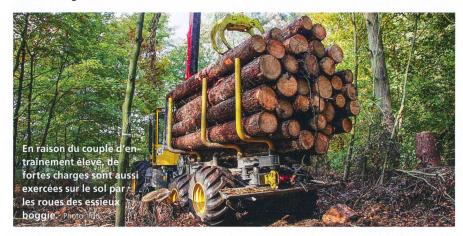
La répartition de charge la plus uniforme possible sur toutes les roues constitue un critère important pour assurer la durabilité des layons de débardage et des chemins forestiers. Les machines forestières disposent de six et huit roues sur essieu oscillant supportant le châssis du véhicule. Cela donne d'excellentes capacités de franchissement des obstacles ou des fossés.
