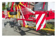
Sur les remorques de travail de plus de 2,10 m de large, deux feux de gabarit visibles de l'avant (blanc) et deux feux de gabarit visibles de l'arrière (rouge) sont nécessaires.
