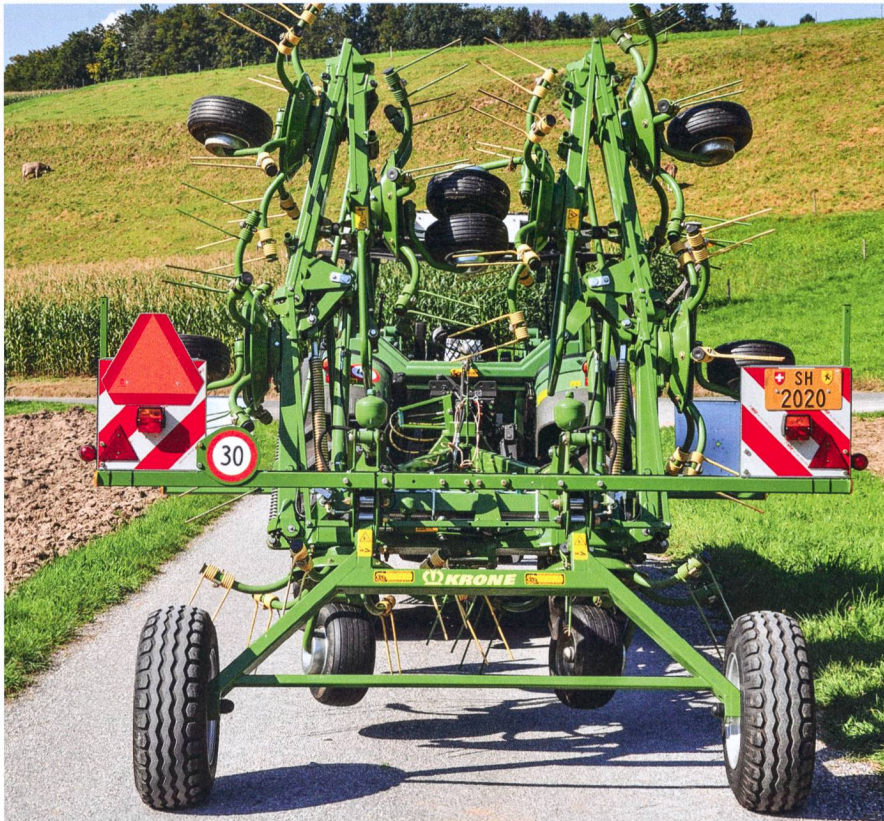
Les remorques de travail de plus de 2,10 m de large ou de 7 m de long doivent être équipées de feux de gabarits. Photos: SPAA
