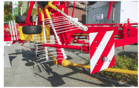
Sur les remorques de travail de plus de 2,10 m de large, deux feux de gabarit visibles de l'avant (blanc) et deux feux de gabarit visibles de l'arrière (rouge) sont nécessaires.
