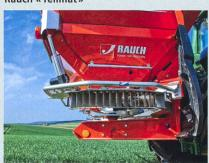
Placés sur le côté gauche ou sur le côté droit de l'épandeur, les limiteurs dévient le flux d'épandage ou limitent l'envol de l'engrais. Ces dispositifs d'épandage en bordure peuvent être actionnés depuis la cabine par une commande hydraulique ou électrique et coûtent entre 1000 et 2000 francs. Les dispositifs d'épandage en bordure de ce type garantissent une qualité de travail élevée.
