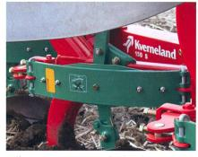
vail. Les systèmes hydrauliques permettent de régler le déclenchement en variant la pression. Les dispositifs mécaniques s'ajustent en modifiant la précontrainte du ressort ou en adaptant le nombre de ressorts à lames. Les changements de pression ou de la précontrainte ne doivent se faire qu'en conformité avec le mode d'emploi.
