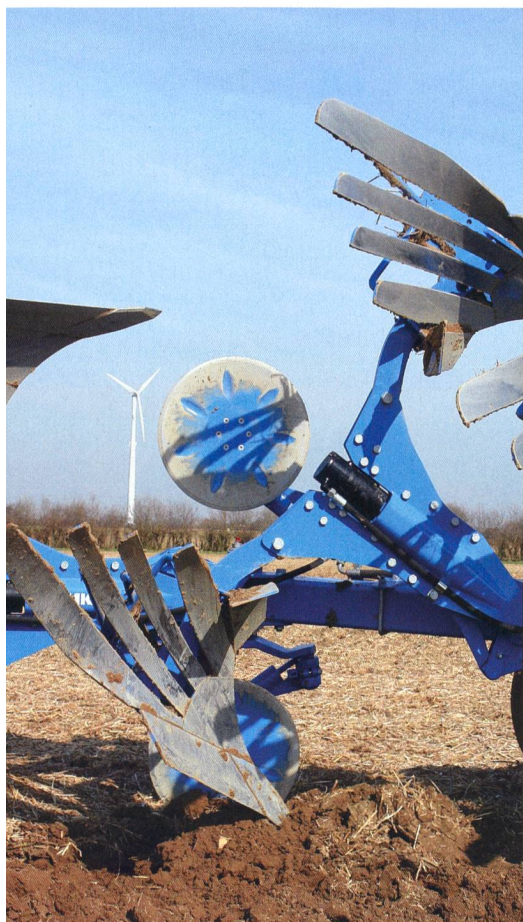
Les protections antipierres et anti-surcharge préservent la charrue de dommages importants. Photo: Lemken
