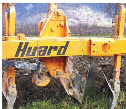
Les protections antipierres et anti-surcharge préservent la charrue de dommages importants. Photo: Lemken
