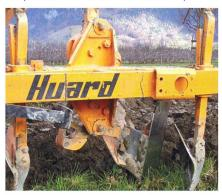
support à cran d'arrêt. Lorsqu'un certain seuil de pression est franchi, le dispositif lâche et le corps de charrue pivote.
