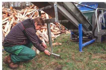
Des supports stabilisent la machine et le tapis de transport.
