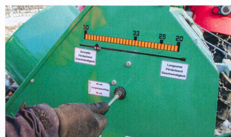
Réglage hydraulique de la longueur avec variation importante.
