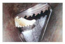
Scie circulaire: 42 dents, épaisseur de 4,5 mm et diamètre de 700 mm.
