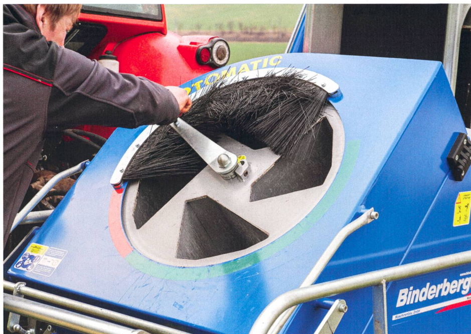
La « Rotomatic EZ » de Binderberger dispose d'un réglage de la longueur en continu grâce à une clé à douille.
