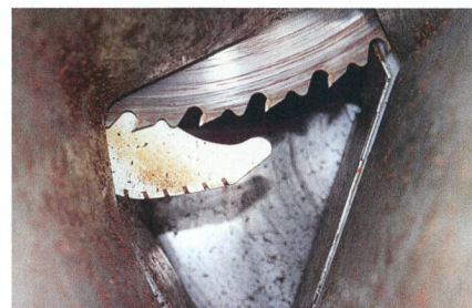
Scie circulaire : 42 dents, épaisseur de 4,5 mm et diamètre de 700 mm.
