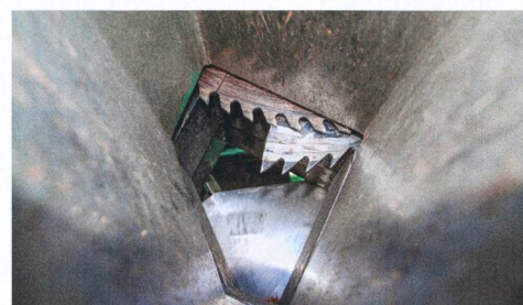
Scie circulaire : 60 dents, épaisseur de 4,2 mm et diamètre de 700 mm.
