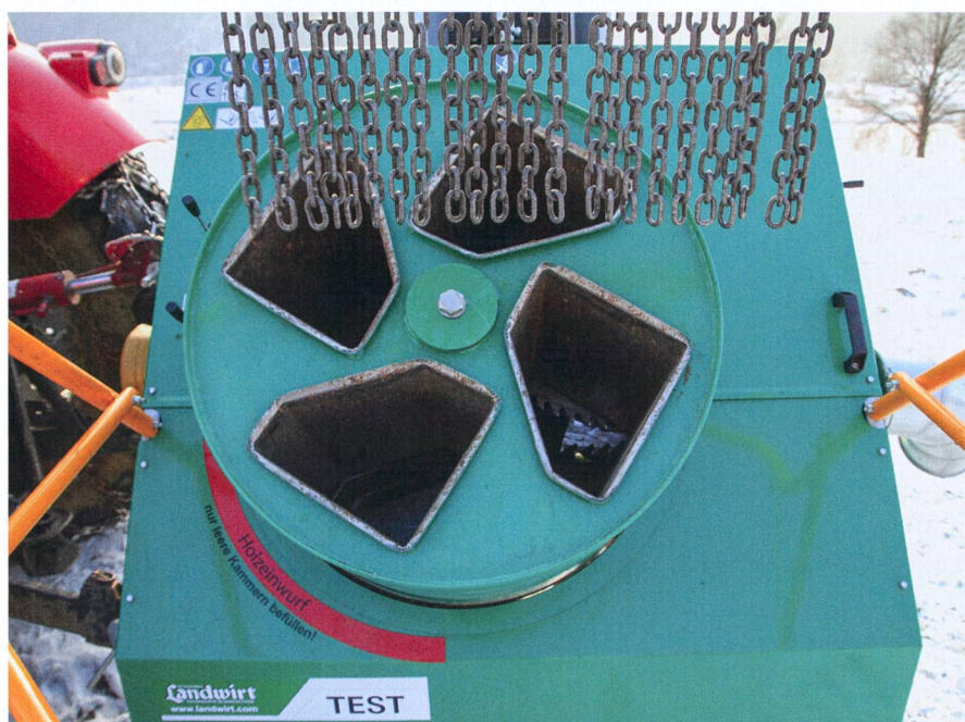
Le tambour de la « Rotomat » de Kretzer est le seul à tourner dans le sens inverse des aiguilles d'une montre.
