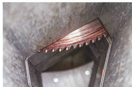
Scie circulaire : 120 dents, épaisseur de 5,2 mm et diamètre de 700 mm.
