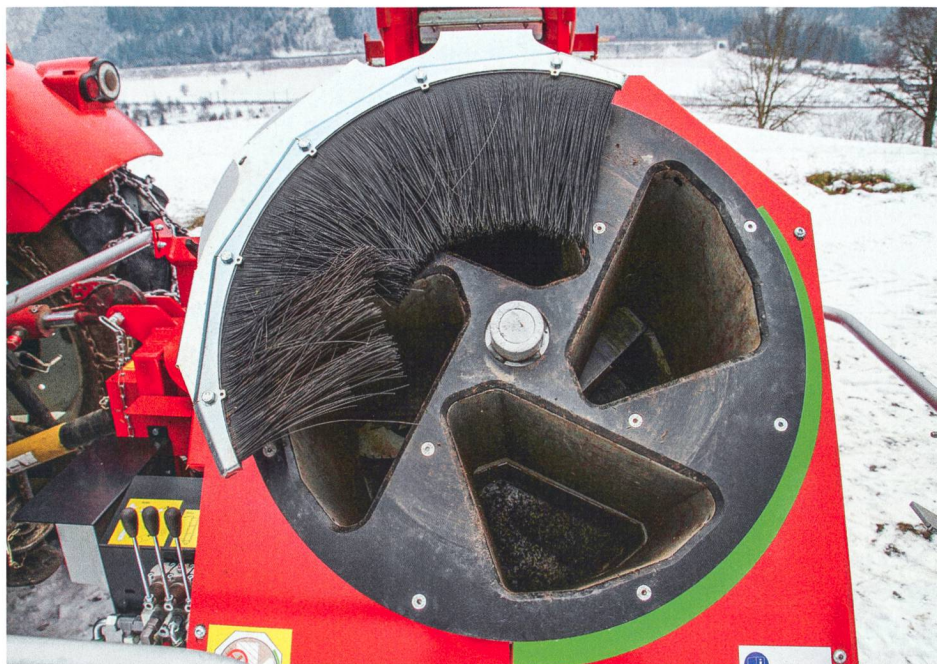
La « Quatromat » d'Unterreiner comporte un tambour à quatre canaux d'alimentation et d'un réglage de la vitesse en continu.
