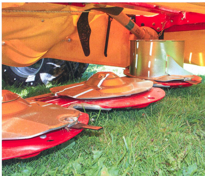
Fella n'intègre que quatre disques de fauche, mais ils sont d'un diamètre important.
