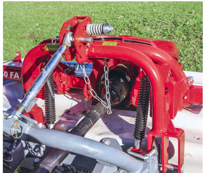
Attelage avec sécurité anticollision en option.
