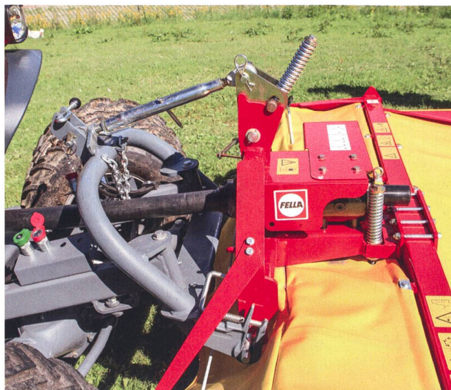
Attelage compact de la catégorie I avec sécurité anticollision de série.
