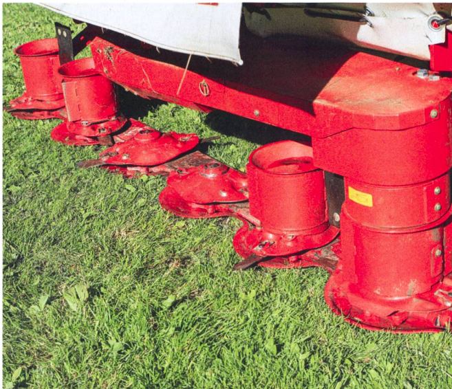
Les élévations en forme de tambours placées sur les disques permettent la formation d'un andain propre.
