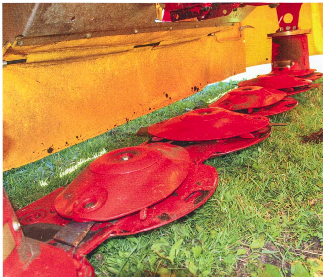
Les couteaux pincés et la finesse du lamier ont permis un travail propre dans toutes les conditions du test.
