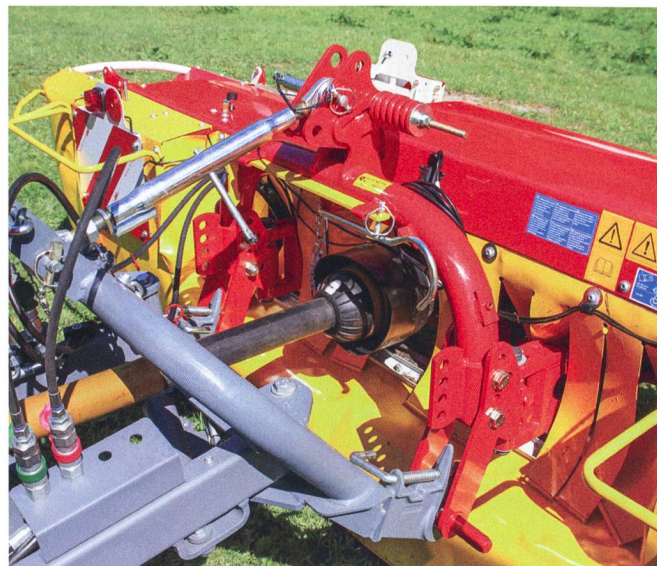
Attelage de la catégorie I et II avec sécurité anticollision de série.
