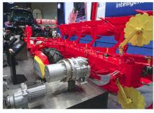
ZF a développé un large éventail de systèmes d'entraînements électriques. Des générateurs à haute ou à basse tension montés dans le tracteur transforment la puissance mécanique du moteur à combustion en énergie électrique, qui peut par exemple être utilisée pour entraîner la roue d'une charrue et permettre d'obtenir une meilleure traction.
