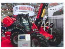
«MLA-T» correspond au concept de Manitou avec le joystick « JSM » à l'accoudoir. Le diamètre de braquage réduit, I'« hydraulique intelligente » et le dispositif d'amortissement « Active CRC » devraient constituer d'autres avantages qui distinguent ce véhicule.
