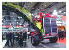
remédier à cette lacune avec la « buffalo », un système de chargement à rotor avec bunker intermédiaire qui combine de manière innovante les composants connus des autochargeuses (pickup, rotor de coupe), des presses à balles (bunker) et des ensileuses (dispositif de transbordement). Le fourrage est ramassé, haché et stocké dans le bunker intermédiaire, puis transféré dans une remorque de transport indépendante.
