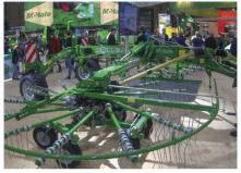
transport, les toupies dressées se déplacent vers le bas, afin que la hauteur du convoi soit inférieure à 4 m. La machine qui est tractée est équipée de pneus de série 380/55-17 conçus pour une vitesse de 40 km/h.
