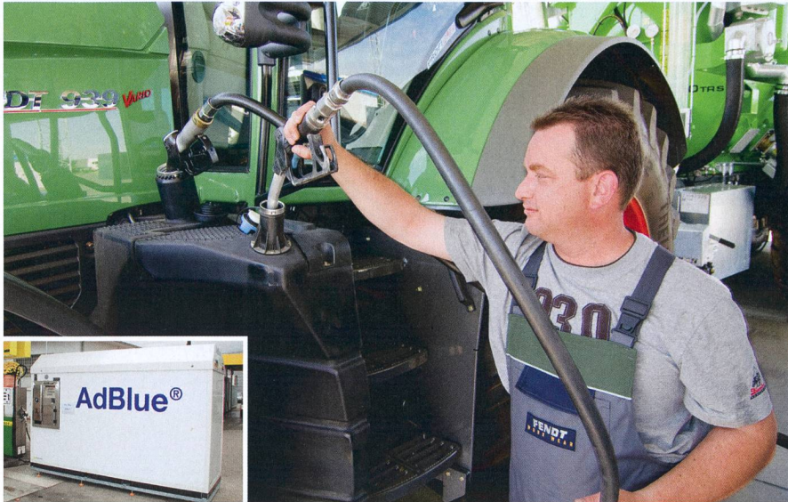
L'AdBlue est stocké dans un réservoir supplémentaire installé sur le véhicule. La solution d'urée est de plus en plus proposée dans les stations-services (petite photo).
