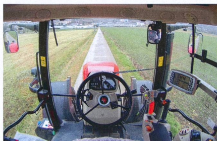
La cabine du «6718 S» avec la transmission «Dyna-6» est aménagée de façon fonctionnelle et offre une bonne vue d'ensemble.
