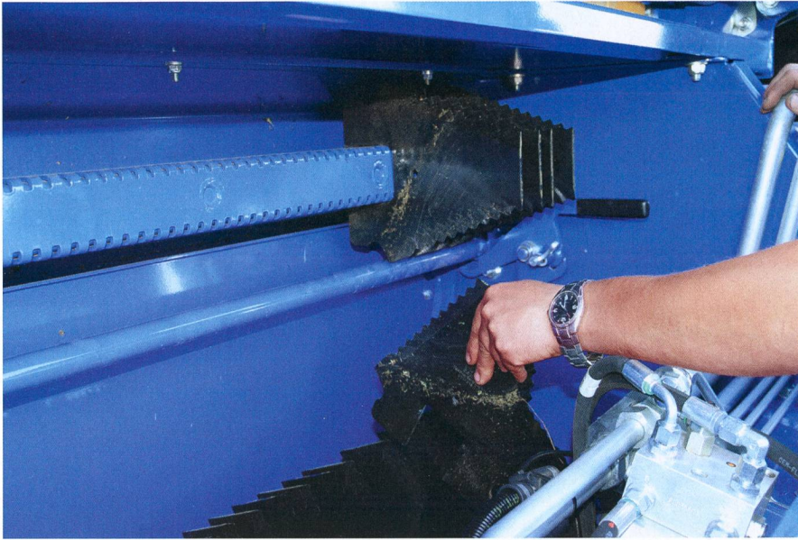
L'opérateur peut changer les couteaux, placés au-dessus du rotor, en gardant une position confortable. Photo: Johannes Paar
