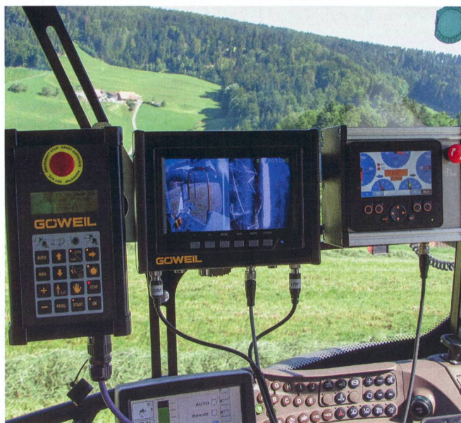
Le terminal de commandes de la machine combinée est petit mais efficace. Le système d'entraînement de l'essieu est géré par un module séparé, doté d'un écran couleur.
