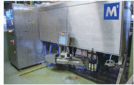
«Merlin» est au cœur de l'automatisation de l'étable d'Alois et Anita Moos. Le robot de traite est doté de moteurs électriques pour un fonctionnement silencieux.
