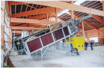
Dans la cuisine, quatre réserves sont aménagées pour garantir le remplissage régulier du robot d'affouragement avec les ingrédients nécessaires.
