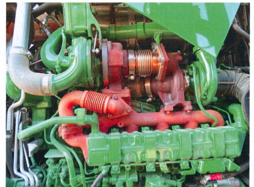
Le moteur « Power Tech » (PSS) de John Deere, d'une cylindrée de 6,8 l, et des turbocompresseurs en série, atteint une puissance de 300 ch.
