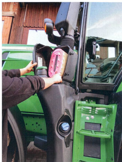
Pratique: la cartouche de filtre à air est montée à gauche de la montée.
