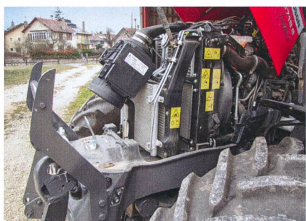
L'espace entre les radiateurs est suffisant pour permettre les opérations de nettoyage.
