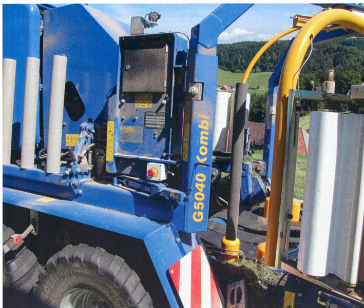
Toutes les fonctions peuvent être commandées manuellement depuis la machine lorsque le conducteur quitte son poste ou en cas de défaillance électronique.
