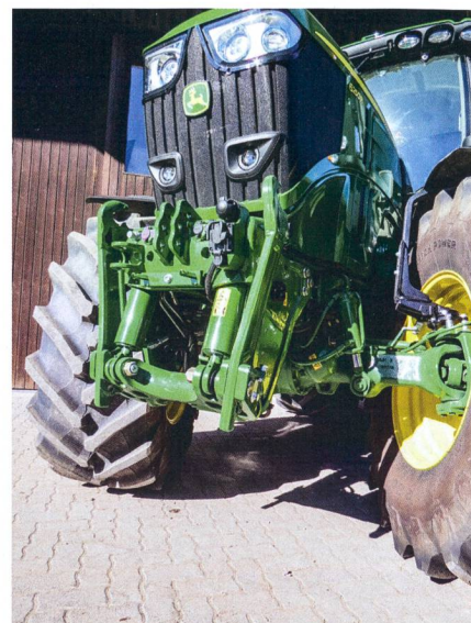
Fourni de série, le système d'hydraulique avant compact soulève 5000 kg.
