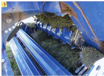
Le rouleau profilé accélère le passage du fourrage du pick-up au rotor.
