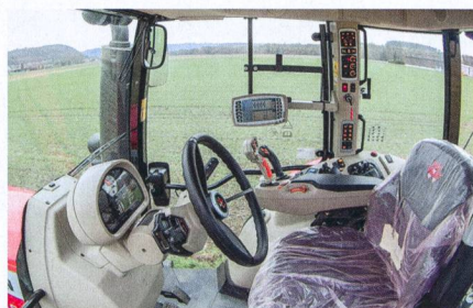
Les deux principaux instruments de commande, le levier multifonctions et le joystick, sont intégrés à l'accoudoir.
