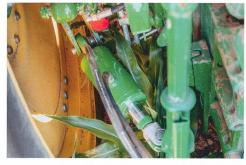
Un développement conjoint de Monosem et John Deere permet la conduite précise des outils de hersage avec le bras inférieur.
