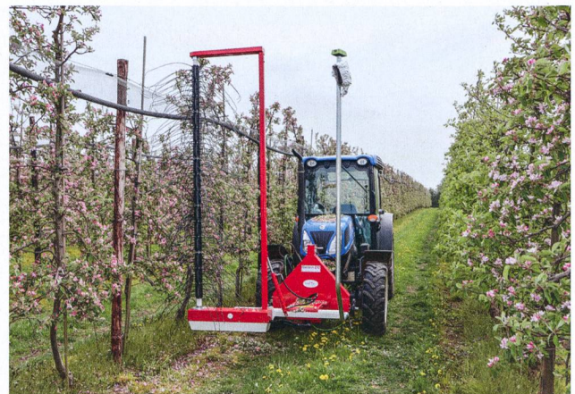
Avec le système assisté par caméra « Darwin SmaArt » de Fruit-Tec Adolf Betz, l'éclaircissage des fleurs et des fruits peut être automatisé.
