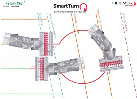
Avec le «SmartTurn» développé par Holmer et Reichhardt, l'arracheuse tourne automatiquement en bout de champ.
