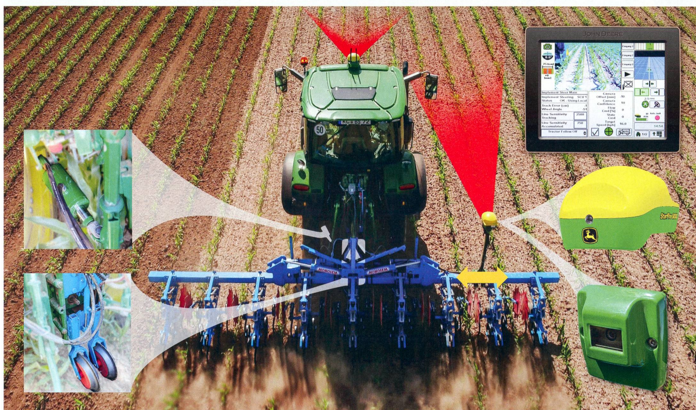
Le guidage automatique des outils de hersage revêt une importance croissante en raison de son efficacité élevée. Photos: Idd
