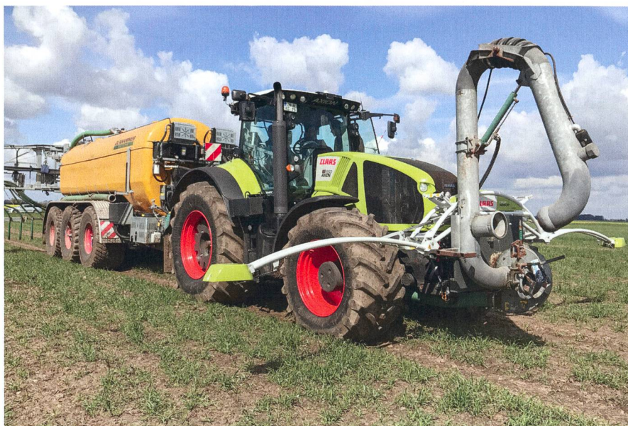
La combinaison de deux systèmes de capteurs permet aujourd'hui d'épandre le fumier sur des surfaces spécifiques. Photo: Zunhammer
