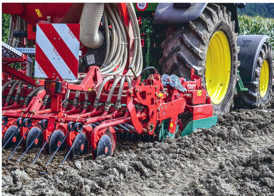
Le capteur d'engorgement employé en technique d'épandage est désormais présent aussi sur des semoirs pneumatiques. Photo: Ruedi Hunger
