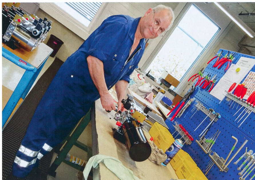
Des solutions spécifiques comme ce vérin de levage sont réalisées dans les propres ateliers de Paul Forrer AG. Photos: Roman Engeler
