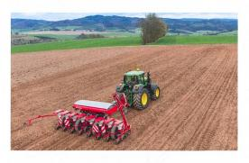
ment semeur en surpression, avec lequel les ingénieurs de Kverneland ont intégré une nouvelle technologie de séparation dans l'« Optima ». Les grains subissent une accélération pneumatique qui les projette dans le sillon à des
