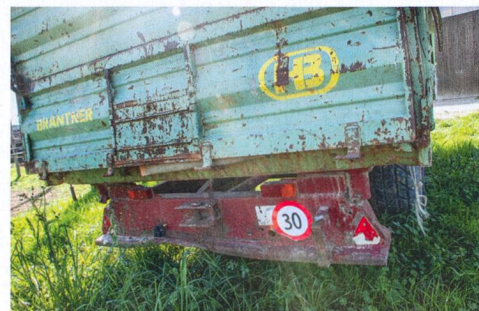
Cet attelage ne peut pas encore rouler sur la route: les catadioptrés triangulaires défectueux sont à remplacer. Il manque encore le triangle de signalisation.
