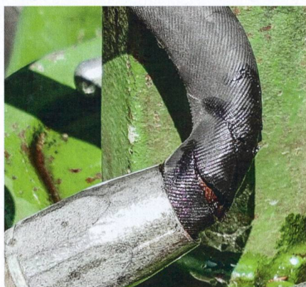
La situation peut devenir dangereuse si des flexibles hydrauliques fissurés éclatent.
