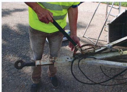
La plupart des défauts, tels que le frein de stationnement défaillant ou le dispositif d'attelage déformé, sont décelés sur les remorques limitées à 30 km/h.
