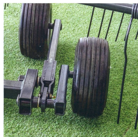
Un essieu tandem breveté sur les andaineuses rotatives de type « Star » pour une adaptation optimale au sol.
