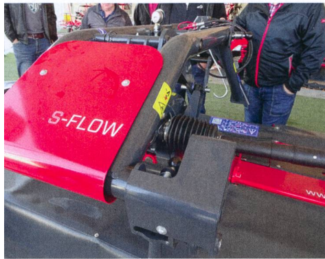
Même à grande vitesse, la tête d'attelage tirée « S-Flow » élaborée pour les faucheuses frontales s'adapte aux irrégularités du sol.
