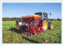
Le semoir à disques « DP 300 » de 3 mètres de largeur de travail et doté d'un système de suspension mécanique de marque Maschio Gaspardo est équipé de 17 disques. Ce
