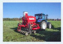
Le semoir « GD 3000 M » de l'entreprise familiale anglaise Weaving est équipé d'un système resserré de doubles disques dont un denté. Ce système soulève légèrement la terre
