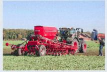
Le semoir tracté de 6 mètres « Avatar 6 SD » de Horsch est aussi bien adapté au semis conventionnel, direct que sous couvert. Il est équipé de 36 monodisques. L'asso-
