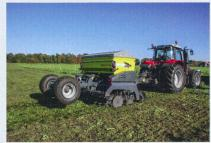
L'« Easy Drill » de Sky est un semoir tracté pour semis direct de 3 mètres de largeur de travail équipé de 18 dents agressives et disposées verticalement. Cela permet d'éviter que
