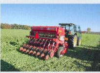
travail de 2,4 mètres et 15 doubles disques espacés d'une distance de 16,5 cm. Ce semoir est particulièrement léger (2300 kg). Selon son propriétaire, 50 chevaux suffisent amplement pour tracter ce modèle. La profondeur de pose de chaque disque est réglable individuellement. Ce semoir est doté d'un guidage des socs.
