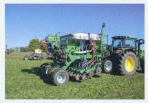
semoir lourd de 5000 kg et large de 3 mètres présente 20 rangs espacés de 15 cm ainsi qu'un système de 3 disques équipé d'un Turbo-Coulter en amont du disque double. Les 3 trémies garantissent un apport simultané de semences, d'engrais et d'hélicide. Poids de ce semoir tracté et guidé par les roues: 5000 kg. Le réglage de la profondeur est centralisé pour tous les éléments semeurs. L'effort de terrage sur les disques est de 150 kg.
