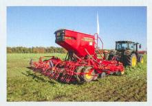
Le semoir tracté « Rapid A 400 S » de Väderstad est également aussi bien adapté au semis direct, conventionnel que sous couvert. L'effort au terrage sur les 32 disques peut
