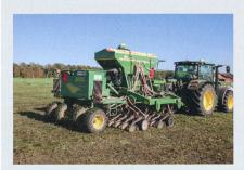
Le semoir tracté de 4 mètres pour semis sous couvert « 750 A » de John Deere présente 24 monodisques ainsi qu'un équipement électrique auxiliaire de la firme Landag AG (Seedorf, can-
