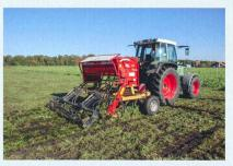
couvre une largeur de travail de 3 mètres. Ses 1250 kg requièrent une puissance d'environ 90 chevaux. Le réglage de la profondeur de la pose se fait au moyen des roues en amont du châssis et du rouleau cage placé derrière le châssis. Ce semoir est guidé par le châssis.
