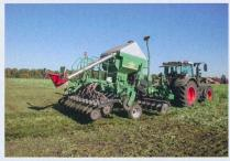
Le « NTA 1300 » de 4 mètres et de 24 rangs de Great Plains est un semoir tracté pour semis universel présenté à Bellechasse. Ce semoir est équipé à l'avant de roues Turbo-Coulter
