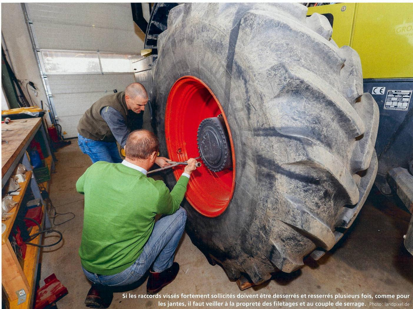
Si les raccords vissés fortement sollicités doivent être desserrés et resserrés plusieurs fois, comme pour les jantes, il faut veiller à la propreté des filetages et au couple de serrage. Photo: landpixel.de
