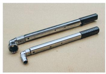
Le couple de serrage recommandé ne peut être obtenu qu'avec une clé dynamométrique. Serrer au feeling est trop imprécis pour des vis importantes. Les tableaux de correspondance, publiés sur Internet, indiquent les couples de serrage recommandés.
