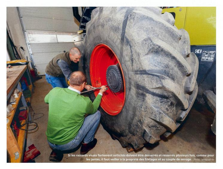
Les assemblages par vis peuvent être conçus soit ajustés, soit emboîtés. Dans la variante à emboîtement positif, les vis de montage sont fixées au moyen d'un alésage précis sans jeu. Le glissement des pièces vissées de cette façon est également assuré sans forte pression de contact et avec un couple de serrage faible. En raison de la précision nécessaire, la production de vis à emboîtement est complexe et elles ne sont donc utili-
