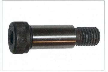
Dans le cas des assemblages emboîtés, on utilise des vis de montage à épaulement dont la tige s'insère sans aucun jeu selon un alésage précis. Ce type de connexion à vis est coûteux et utilisé lorsque les deux parties à visser sont positionnées avec précision.
