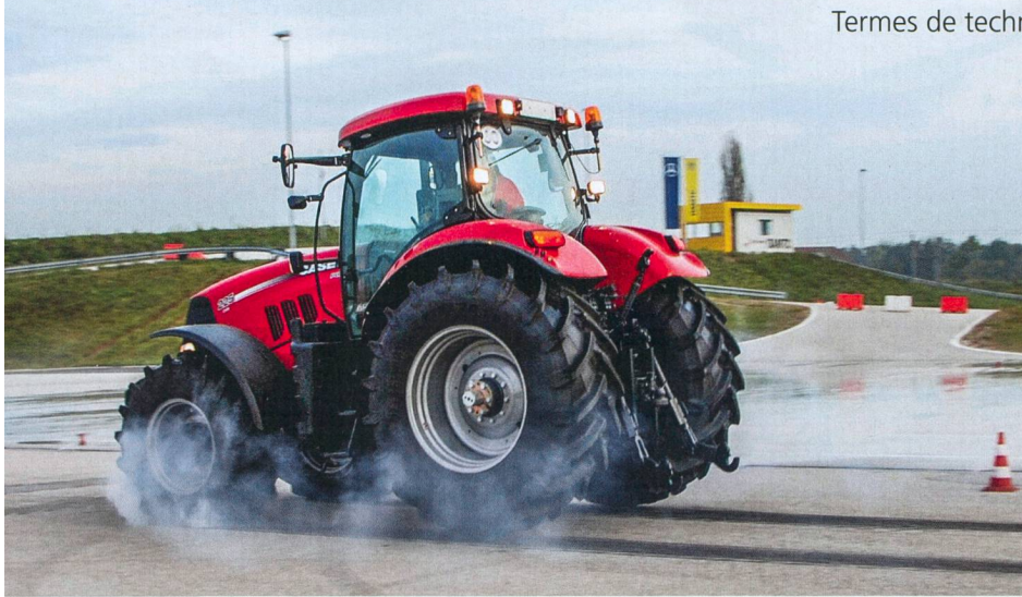
Le système d'antiblocage ABS empêche le blocage des roues et réduit la glissade et le dérapage. Photo: Roman Engeler
