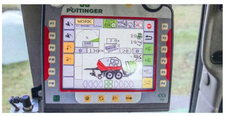
L'«Impress» dans sa version «Pro» est compatible Isobus. La machine testée était équipée du terminal «CCI 100».
