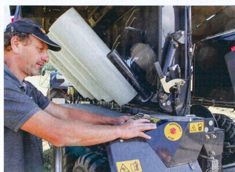
Le magasin de rouleaux de film et toutes les fonctions d'enrubannage peuvent également être commandés depuis l'arrière.
