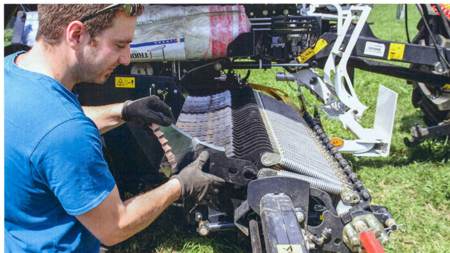
La barre extractible facilite grandement la maintenance des couteaux.
