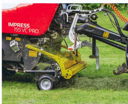
Le pick-up pendulaire guidé à plat ramasse le fourrage proprement même sur terrain fortement accidenté.
