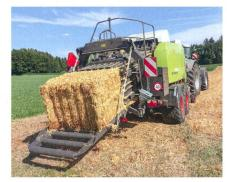
Le canal de presse comporte un volet de compression supérieur continu. Ainsi, les plaques angulaires supérieures disparaissent et le matériau récolté est uniformément comprimé sur toute la largeur.
