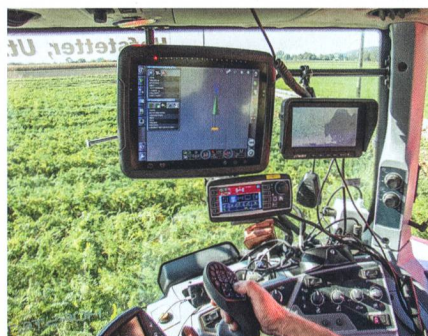
Le système de guidage automatique est géré depuis l'imposant terminal «C3000» et son écran tactile.
