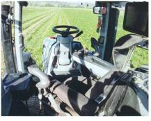
Le siège à accoudoirs avec les deux modules de commande de l'arracheuse pivote vers la gauche et vers la droite.
