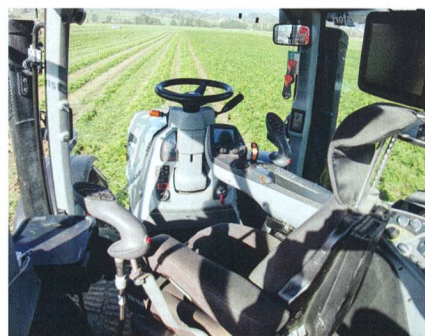
Le siège à accoudoirs avec les deux modules de commande de l'arracheuse pivote vers la gauche et vers la droite.
