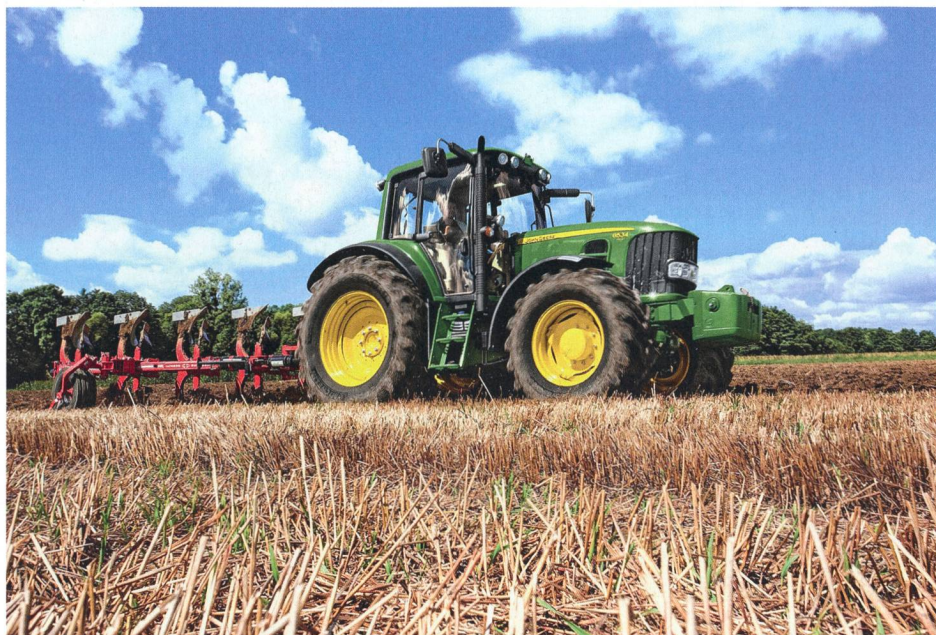
Le changement des rapports sans actionnement de l'embrayage ni interruption de la force de traction est requis lors des opérations de travail du sol. Photo: John Deere
