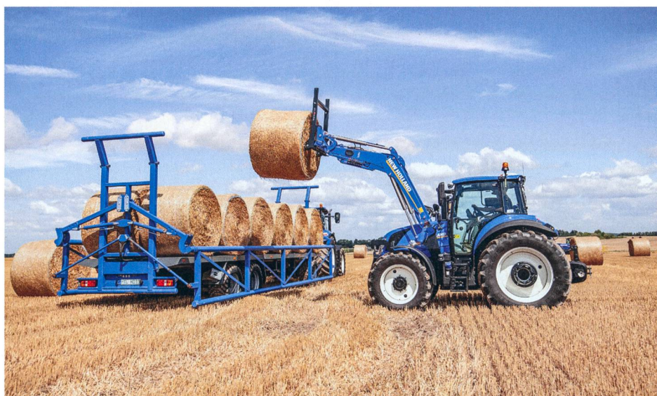
Un travail efficace avec le chargeur frontal exige que l'inversion du sens de marche se fasse rapidement. Photo: New Holland
