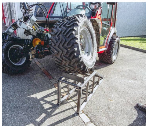
Une oscillation d'essieu jusqu'à 15 degrés est possible (dans les empattements longs) avec les nouveaux modèles «Metrac».
