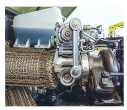
Le clapet sert également de frein moteur, ce qui est typique des moteurs fabriqués par Fiat Power Train (FPT).
