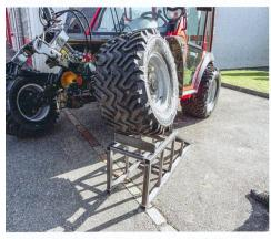
Une oscillation d'essieu jusqu'à 15 degrés est possible (dans les empattements longs) avec les nouveaux modèles « Metrac ».
