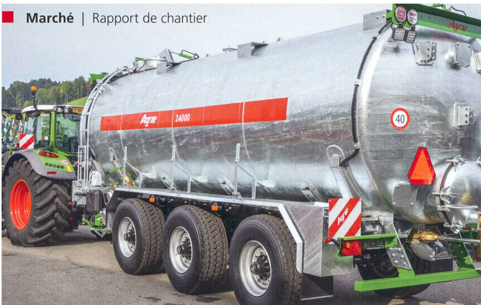
L'assortiment d'Agrar Landtechnik AG contient désormais une tonne à lisier de 24 m 3 dotée de pneus pour camions adaptée au transport sur route. Photos: Ruedi Hunger
