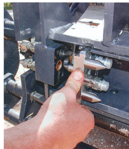
Processus : la station de couplage de l'outil est «connectée» au système de verrouillage du chargeur.
