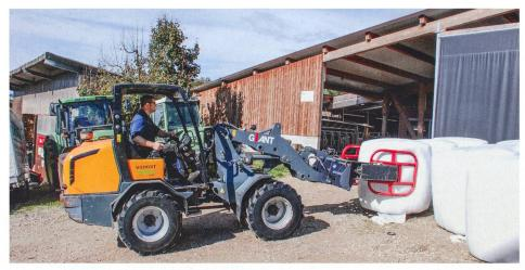
Avec le «Highspeed Oil Coupler», les outils sont montés et démontés rapidement. Ils le sont aussi lorsque les conduites hydrauliques sont sous pression. Photos: Heinz Röthlisberger
