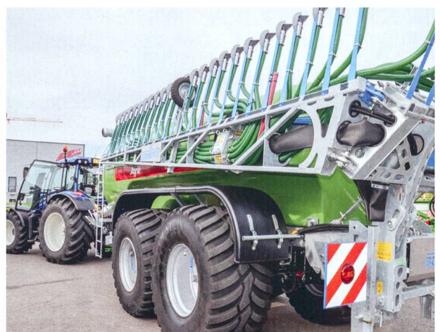
Le «HL-L5» dispose depuis peu de trois rouleaux doseurs et un convoyeur de 75 cm de large (à g.). Les tonnes à lisier d'Agrar Landtechnik disposent en option d'une rampe à patins de Bomech (à d.).
