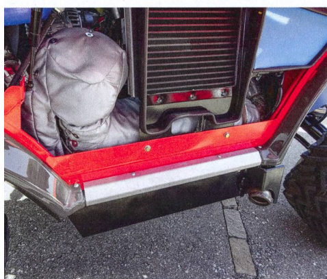
Loger des composantes d'épuration de gaz d'échappement telles que les filtres à particules de diesel, le catalyseur SCR et le refroidisseur nécessaire représente toujours un défi pour les développeurs.
