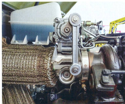
Le clapet sert également de frein moteur, ce qui est typique des moteurs fabriqués par Fiat Power Train (FPT).
