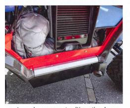
Loger des composantes d'épuration de gaz d'échappement telles que les filtres à particules de diesel, le catalyseur SCR et le refroidisseur nécessaire représente toujours un défi pour les développeurs.
