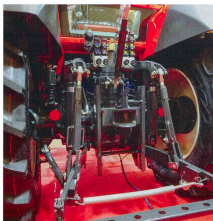
Les vérins de direction sont désormais situés devant l'essieu, de manière à laisser assez de place pour le relevage arrière.
