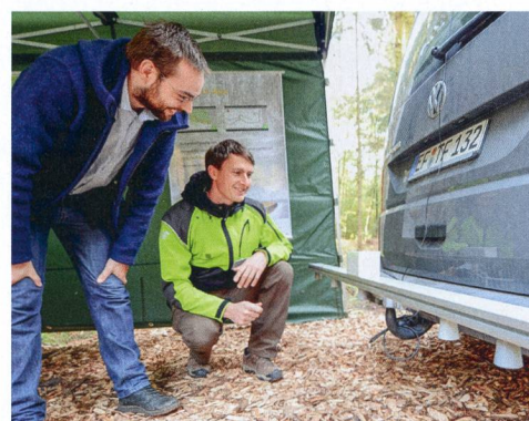
Le scanner fixé à l'auto effectue un relevé de la surface des chemins, permettant de cartographier l'état des dessertes et de planifier leur assainissement.
