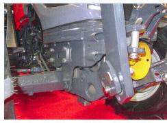
La suspension d'essieu avant optionnelle se base sur le système d'oscillation longitudinale.
