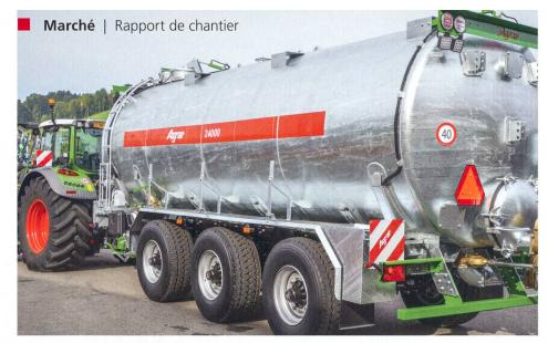
L'assortiment d'Agrar Landtechnik AG contient désormais une tonne à lisier de 24 m³ dotée de pneus pour camions adaptée au transport sur route. Photos: Ruedi Hunger
