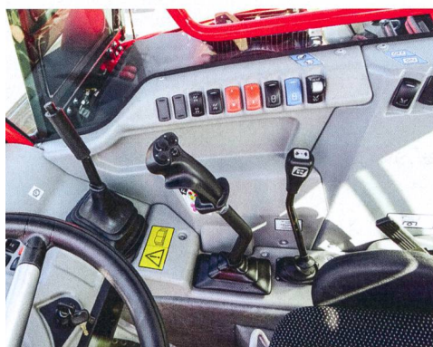
Les éléments de commande sont réunis en «groupes logiques» afin de faciliter et de sécuriser la commande pour le conducteur.
