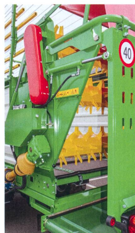
Le «HL-L5» dispose depuis peu de trois rouleaux doseurs et un convoyeur de 75 cm de large (à g.). Les tonnes à lisier d'Agrar Landtechnik disposent en option d'une rampe à patins de Bomech (à d.).
