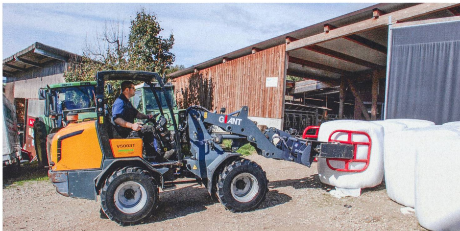
Avec le «Highspeed Oil Coupler», les outils sont montés et démontés rapidement. Ils le sont aussi lorsque les conduites hydrauliques sont sous pression. Photos : Heinz Röthlisberger
