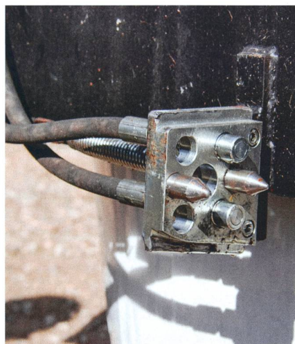
Le système de changement rapide comporte une station de couplage sur l'outil (photo) et un système de verrouillage sur le chargeur.
