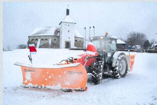
Avec sa gamme « Kalnik », Rasco propose des chasse-neige conçus pour répondre à des sollicitations élevées, devant des gros tracteurs ou des camions. Grâce à leur hauteur de 1,2 mètre, ils permettent de déblayer de
