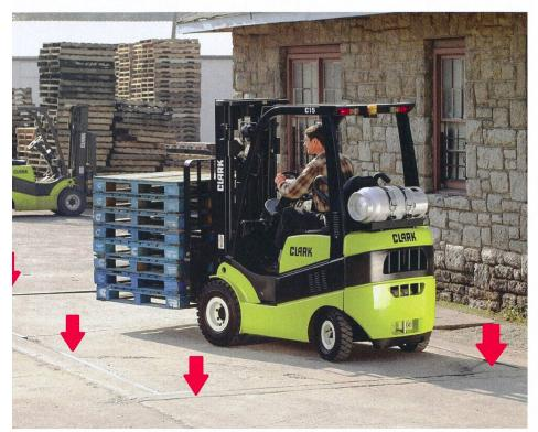
Les joints, les fissures, les trous et les rigoles sont à l'origine de vibrations qui sont une gêne pour le conducteur.
