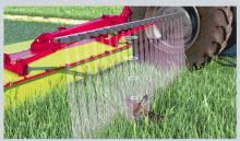
Une solution pour la sécurité des chevreuils Le système à infrarouges optiques avec éclairage à LED « Sensosafe » de Pöttinger.
