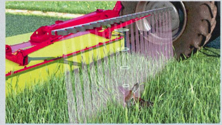
Une solution pour la sécurité des chevreuils ? Le système à infrarouges optiques avec éclairage à LED « Sensosafe » de Pöttinger.
