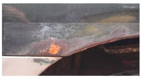
Les dégâts de rouille sur la partie externe de l'aile proviennent souvent de dommages plus importants à l'intérieur. Une bonne prévention grâce à un nettoyage régulier et un traitement saisonnier du châssis en automne vaut la peine dès la huitième année de fonctionnement.
