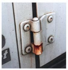
La rouille des charnières des portes d'un véhicule entraîne du jeu et cela peut causer un échec lors de l'expertise du véhicule.
