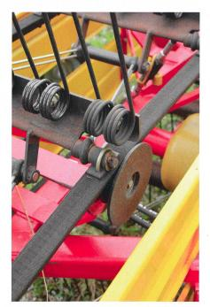
La rouille de parties de machines sans entretien entraîne davantage d'usure en raison de la rugosité de leur surface.
