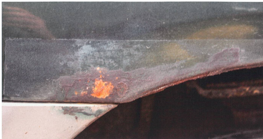
Les dégâts de rouille sur la partie externe de l'aile proviennent souvent de dommages plus importants à l'intérieur. Une bonne prévention grâce à un nettoyage régulier et un traitement saisonnier du châssis en automne vaut la peine dès la huitième année de fonctionnement.
