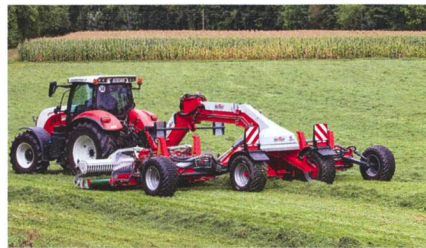
Utilisé en andaineur à dépose centrale, le « Respiro R9 » a une largeur de travail de 9 m.
