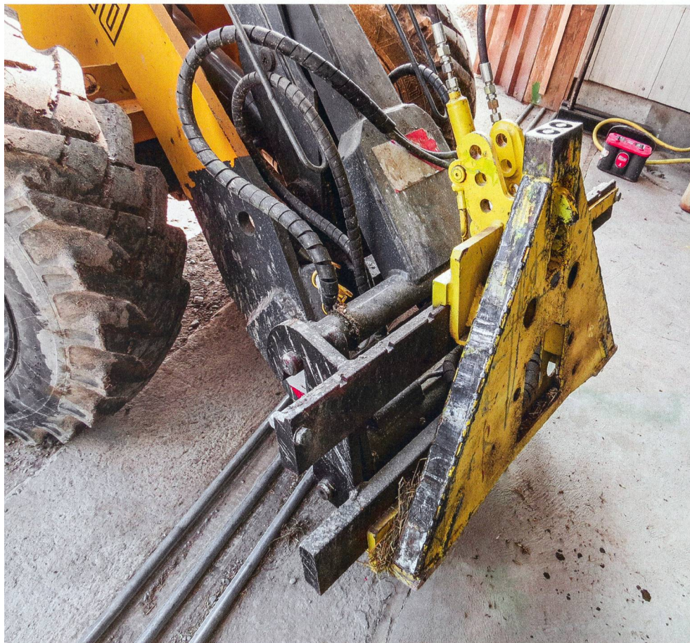
Le module sur le chargeur à roues est glissé par le côté sur le support de base de la fourche à palettes et fixé avec une vis. Selon le type d'engin, le point fort se déplace d'environ 10 cm vers l'avant. Photos: Martin Abderhalden
