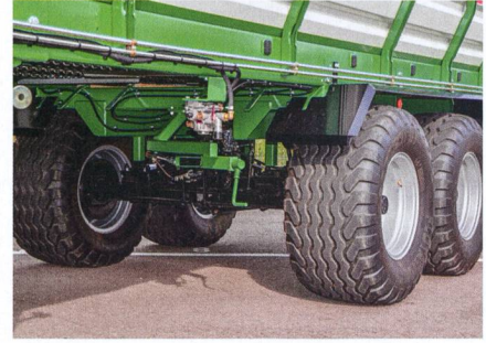
L'essieu tandem directionnel garantit le ménagement du sol et absorbe parfaitement les irrégularités du terrain.
