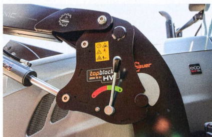
La console «Block HV» se verrouille quand on insère l'engin. Un crochet (argenté sur la photo) enserre le boulon inférieur.
