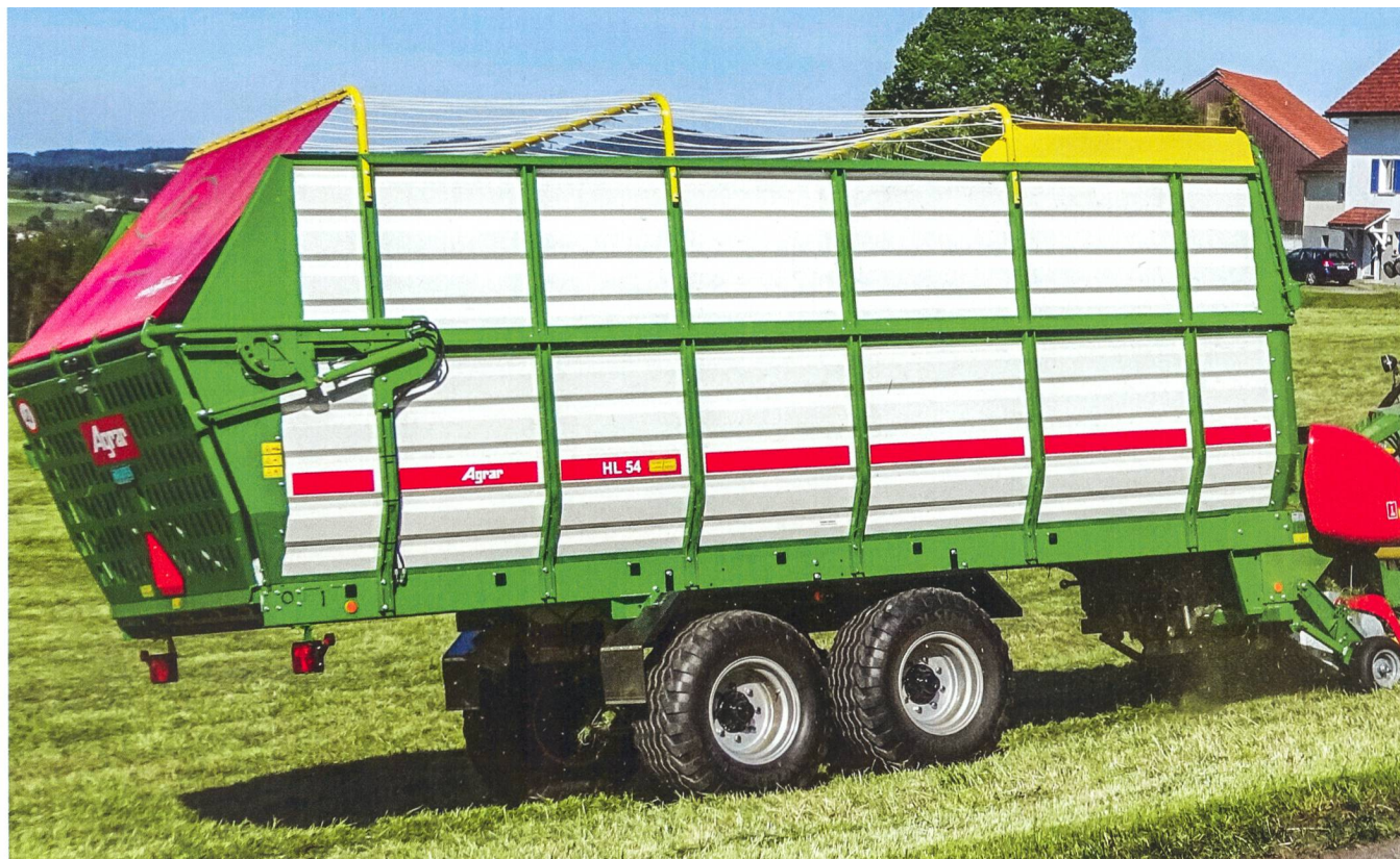
Avec la «HL-L6», Agrar-Landtechnik propose une autochargeuse à hautes performances robuste tout spécialement adaptée aux exploitations herbagères suisses. Photos: Ruedi Hunger et Agrar
