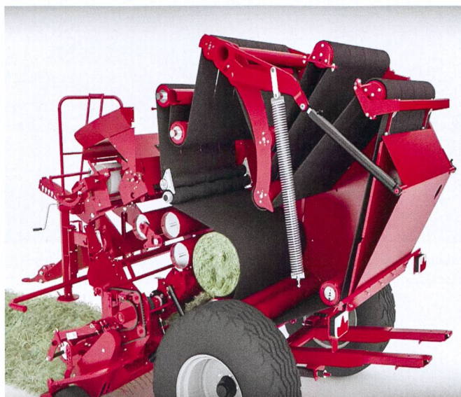
La géométrie spéciale de la chambre de pressage permet, même avec du fourrage cassant, un bon démarrage de la balle.
