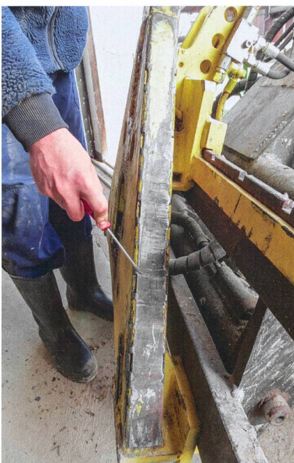
Au bout de plus 5000 opérations d'attelage, l'usure des éléments d'attelage et du verrouillage est à peine perceptible.
