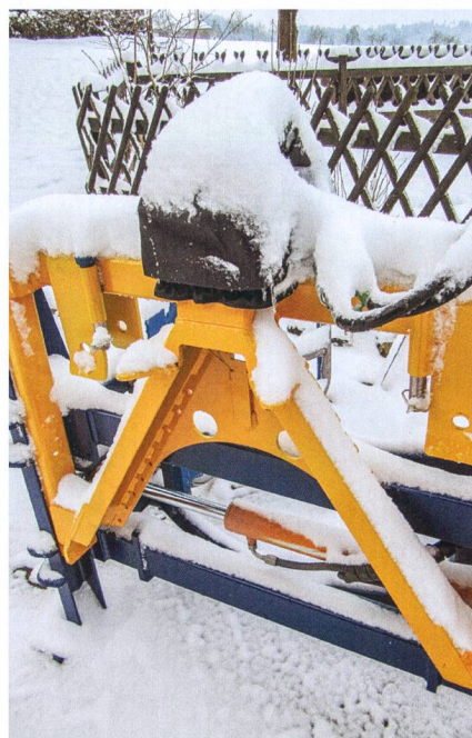
Le capot en néoprène sur la tête d'attelage a fait ses preuves. Même par -10°C, l'humidité et le froid n'ont aucune chance.
