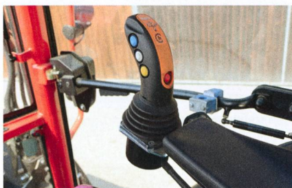
Le levier de commande électro-proportionnel ELC-ergo en option offre certaines fonctions confortables.
