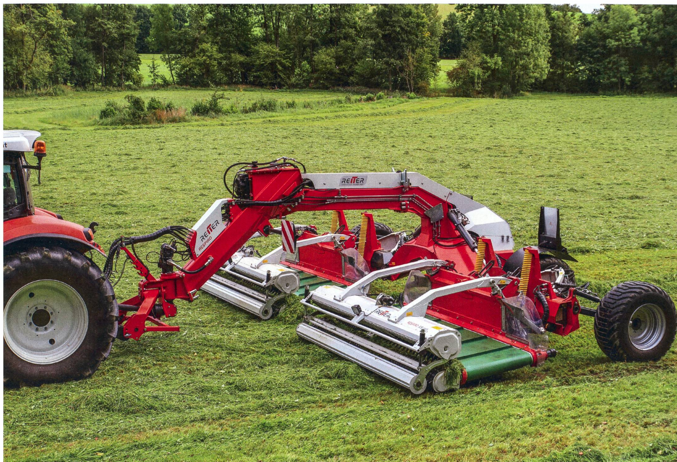
L'andaineur à tapis «Respiro» existe désormais en version traînée avec une largeur de travail maximale de 9m. Photos: Johannes Paar
