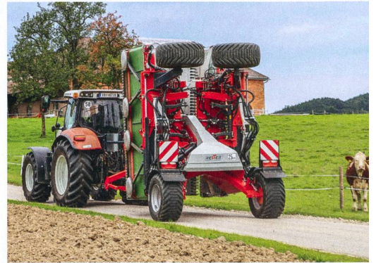
La largeur de transport du « Respiro R9 » ne dépasse pas 2,9 m.
