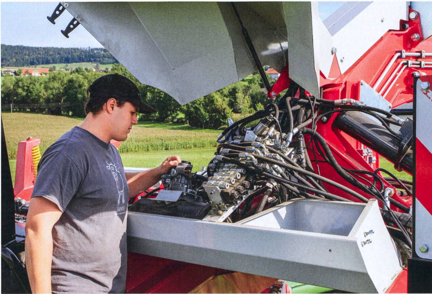
L'hydraulique à bord est complexe. Le réservoir d'huile est intégré dans le cadre.
