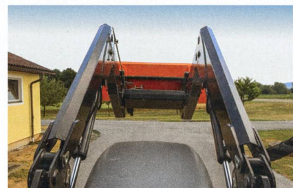
La vue n'est pas gênée par les rampes du guidage parallèle. La vue sur le cadre d'attelage pourrait être meilleure.
