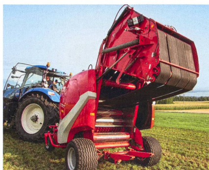
L'ouverture arrière à verrouillage autorise une reprise rapide du pressage après la dépose d'une balle.
