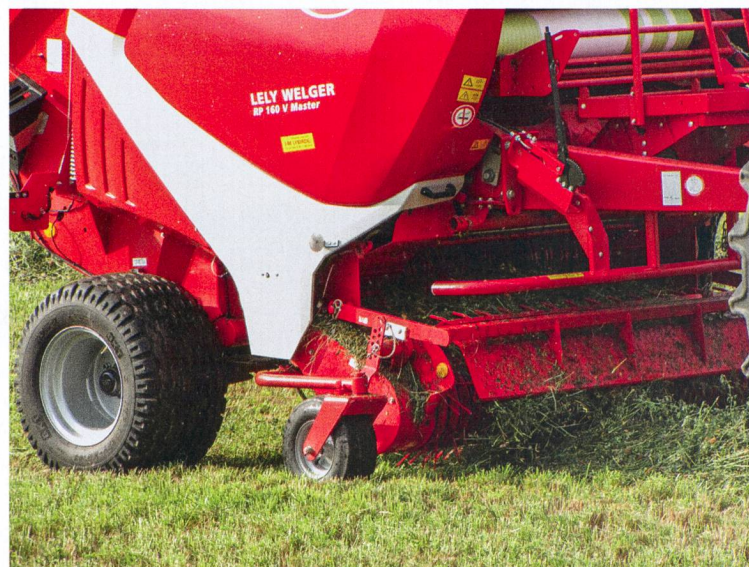
Le pick-up est disponible muni soit d'une tôle, soit d'un rouleau d'appui.
