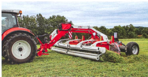
En position rapprochée, les deux unités forment un andaineur à dépose latérale.
