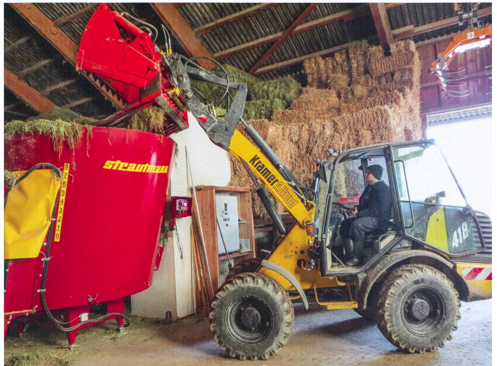
Le chargeur sur roues avec le système « GDS » a été principalement utilisé pour le remplissage d'une installation de mélange et le transport. La lourde pince de coupe d'ensilage a entraîné de fortes contraintes sur le système d'attelage.
