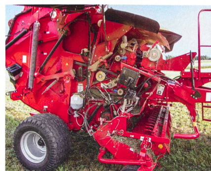
Grâce à des capots à large ouverture, les organes de la presse sont d'un accès facile pour les opérations de maintenance.
