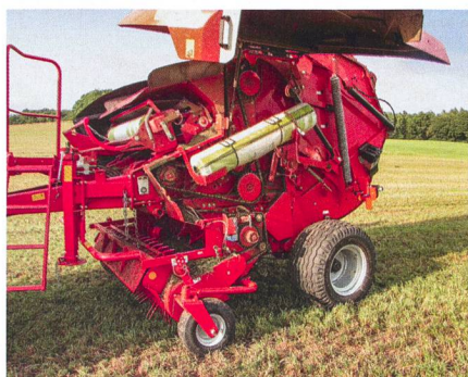
La réserve de filet emportée par la machine se met en place sans grande peine pour l'opérateur grâce à l'« Easy Load Net System ».
