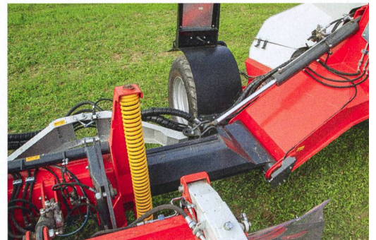
Les unités d'andainage, déchargées à l'aide de ressorts mécaniques, peuvent être décalées d'un mètre vers l'extérieur le long des bras d'extension.
