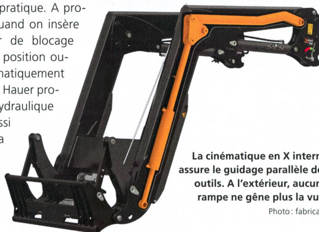
La console «Block HV» se verrouille quand on insère l'engin. Un crochet (argenté sur la photo) enserre le boulon inférieur.
