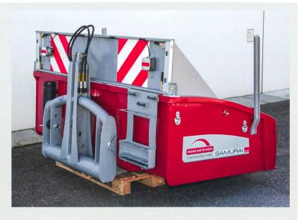
ment de la paroi arrière est plus facile que chez d'autres bennes de basculement. De plus, les fermetures sont bien maniables. La benne, avec une capacité en volume de 1,4 m³, possède la deuxième plus grande cuve du test, après Glinssner. Des parois amovibles existent en option. Deux chariots peuvent être vissés pour transporter des bûches.
