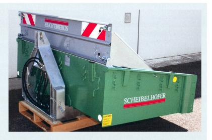
La paroi arrière remplit toutes les fonctions. La profondeur de chargement de près de 1,30 m permet de charger même des europalettes en sens longitudinal. Pour le volume de chargement, « Profi Plus » se situe dans la moyenne avec 1,2 m³. Des parois amovibles existent en option. Pour le transport de bûches, il y a en option quatre ranchers amovibles pour les parois latérales et deux pour la paroi frontale.
