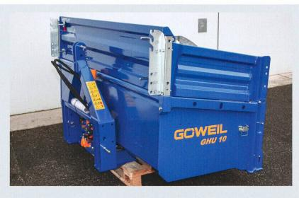
Ont également donné une impression favorable les nombreuses possibilités de fixation du bras inférieur et du bras supérieur avec la meilleure position du centre de gravité, qui se traduit par un faible soulagement de l'essieu avant du tracteur.
