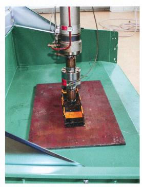
Les mesures de la force de basculement ont été effectuées avec le cylindre gradué posé sur la surface de chargement.
