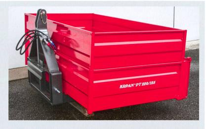
tiques. Il n'y a pas de points d'ancrage pour les sangles d'arrimage. Le cadre au-dessous de la benne a la forme d'une cuve. Lors des travaux d'aplanissement, des saletés et des corps étrangers s'y accumulent au risque de provoquer des pannes. Les côtés pression et aspiration des tuyaux d'huile sont colorés, et il y a un support de rangement pour les tuyaux. Krpan accorde trois ans de garantie.
