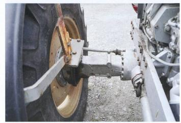
Le différentiel autoblocant Locomatic garantit une transmission automatique de la puissance aux deux roues avant.
