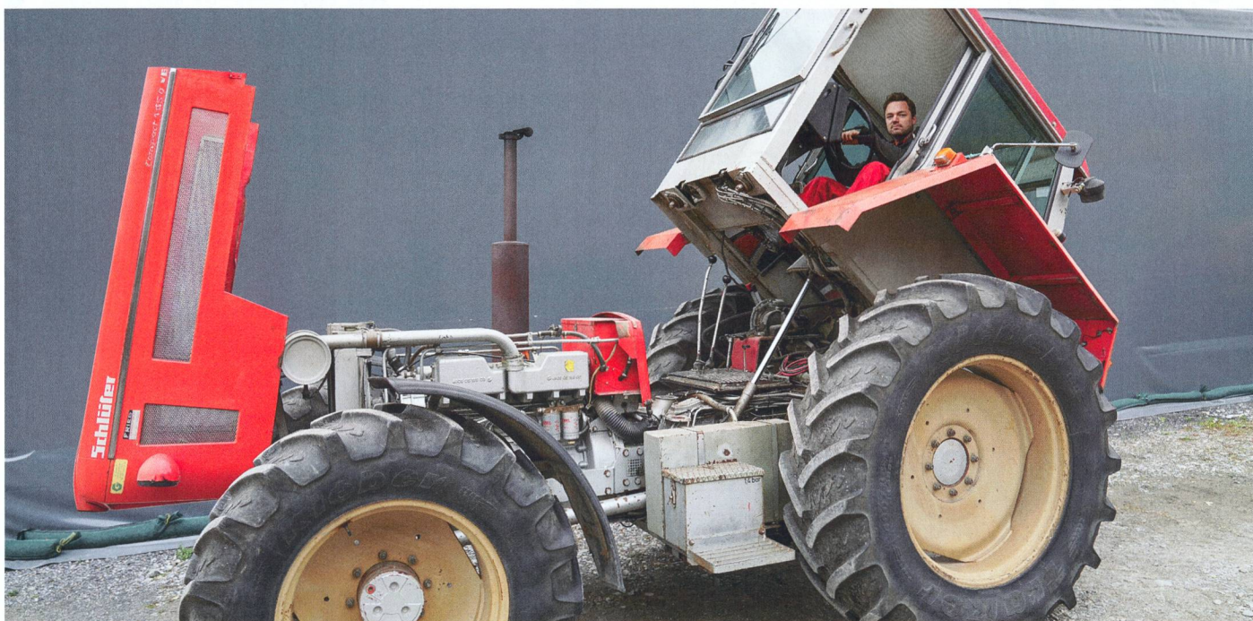
En quelques secondes et sans outillage, le mécanicien agricole Sandro Röschmann bascule la cabine et le capot du moteur. Photos : Dominik Senn
