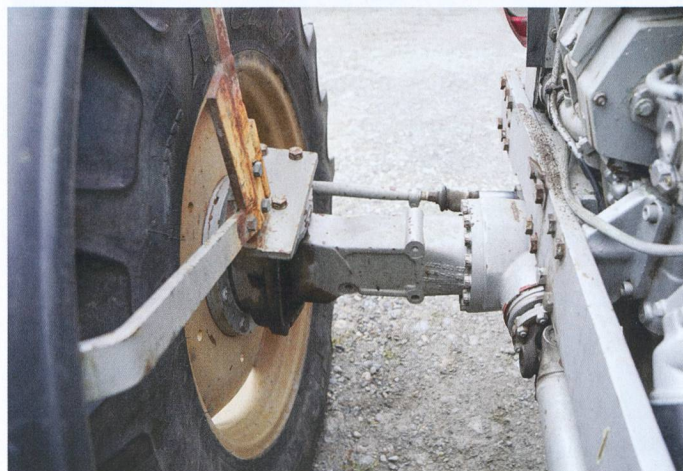
Le différentiel autobloquant Locomatic garantit une transmission automatique de la puissance aux deux roues avant.
