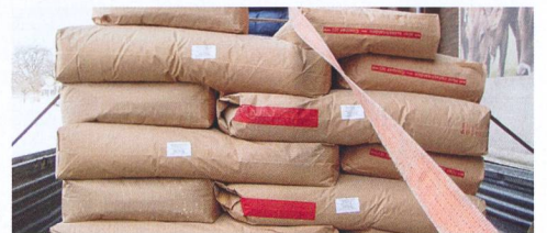
Un chargement doit être arrimé à sa surface de chargement de manière à ne pas pouvoir bouger. Photo: Ruedi Hunger
