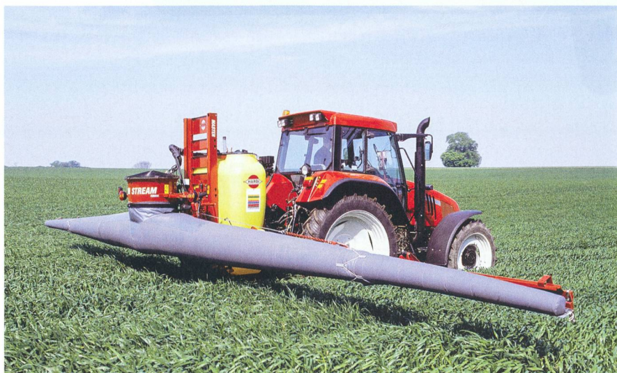
Les rampes à assistance pneumatique réduisent la dérive et améliorent la pénétration dans la culture. Photo : Hardi-Evrard
