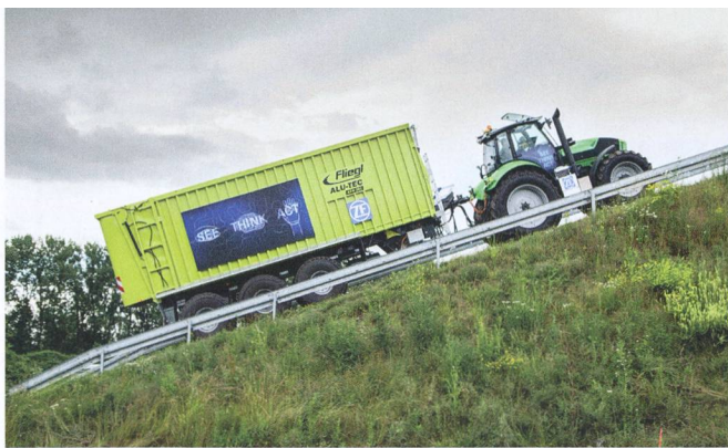
La gestion de la traction de « Innovation Tractor » permet de gravir facilement des pentes atteignant 30 %.
