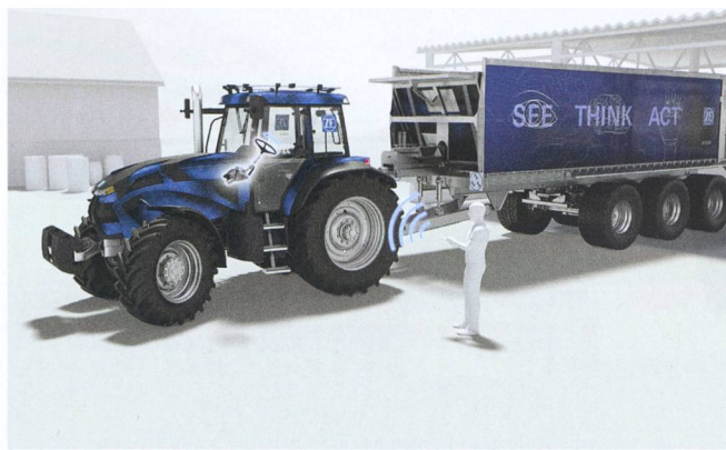
Il est possible de parquer le tracteur en le manoeuvrant depuis l'extérieur de la cabine au moyen d'une tablette électronique.
