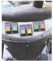
Des fonctions (compensateur d'oscillations pour les déplacements ou déverrouillages de l'outil) se trouvent sous le volant.
