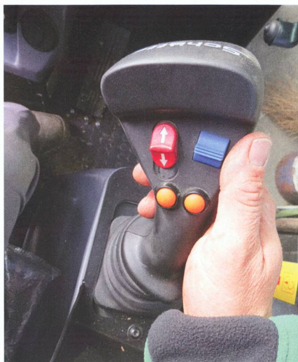
Toutes les fonctions hydrauliques sont regroupées sur le joystick et sur la console latérale. Un accoudoir améliore le confort.
