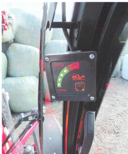
Une alarme informe le chauffeur en cas de délestage de l'essieu arrière. Aucune réaction active n'est toutefois présente.
