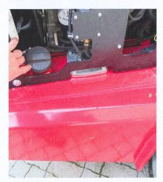
Les réservoirs de diesel et d'huile sont placés dans la partie inférieure du châssis.
