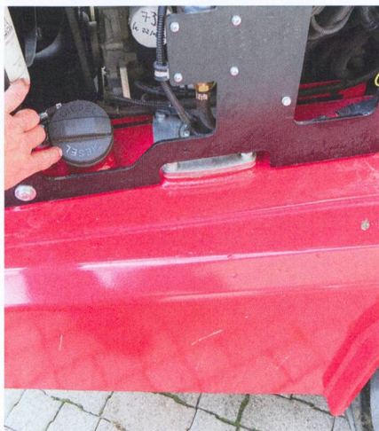
Les réservoirs de diesel et d'huile sont placés dans la partie inférieure du châssis.
