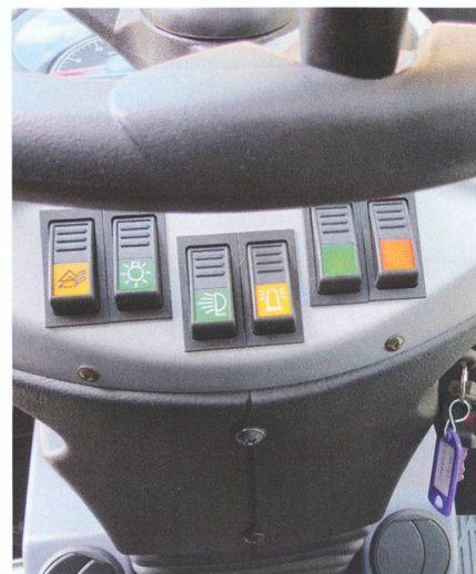
Des fonctions (compensateur d'oscillations pour les déplacements ou déverrouillages de l'outil) se trouvent sous le volant.
