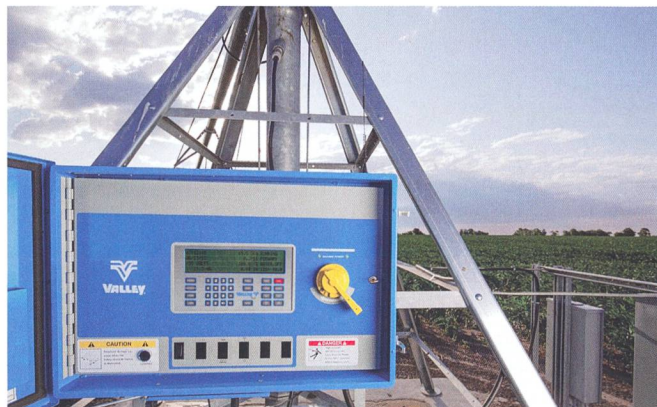
La tour centrale d'un pivot ou d'une rampe frontale est le «cerveau» de l'installation. C'est ici qu'arrive l'eau avant d'être distribuée vers l'installation. Photo: Valley
