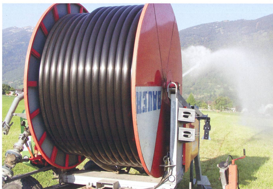
Le développement des tuyaux PE enroulables a permis l'essor de la technique d'irrigation depuis 1970. Photo: Ruedi Hunger
