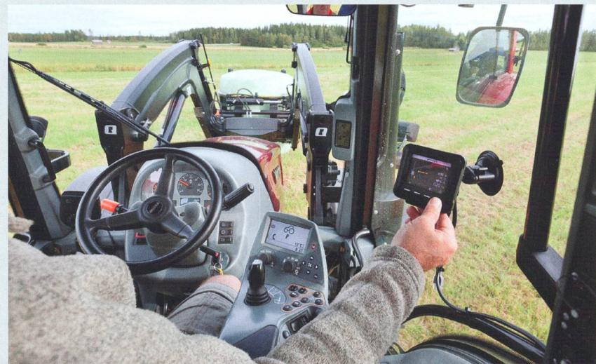
Älö lance sur le marché sa série « Q » de chargeurs frontaux offrant une foule d'améliorations et posant de nouveaux jalons en termes de performances. Un de leurs composants s'appelle « Q-Companion ». C'est un système pour manipuler des charges intégrant un dispositif de pesée, une aide au positionnement et des informations concernant la maintenance. Ce système innovant est appelé à simplifier le pilotage grâce à la présence de capteurs. Le conducteur
