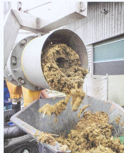
Le liquide et les matières solides du lisier brut peuvent être séparés avec une vis sans fin de compression. Les vis sans fin de compression ont de faibles besoins en énergie et peuvent être utilisées dans différentes exploitations en tant qu'installations mobiles. Photos: Rapport final « Lever »
