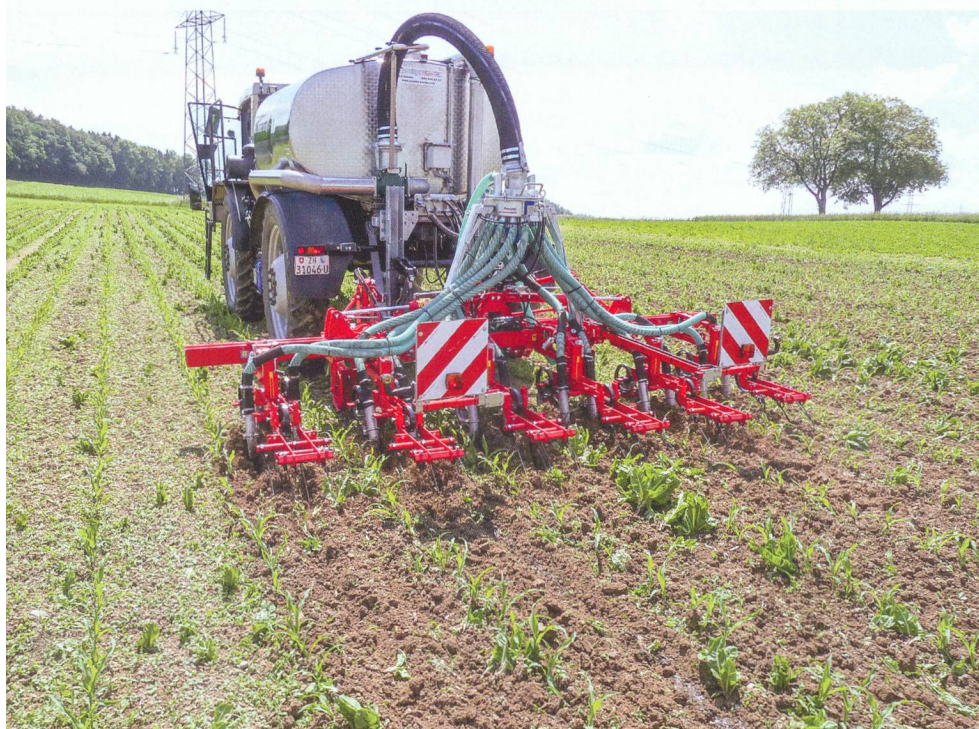
L'automoteur « Hydrotrac » pour l'incorporation de lisier dans le maïs avec sa cuve, sa tête de distribution et les tuyaux installés sur une sarcluse à six rangs. Photos: Roman Engeler et Peter Briner
