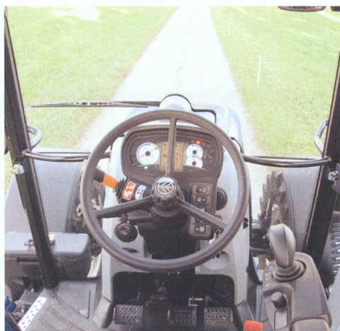
Désormais, le tableau de bord est solidaire du volant et se déplace avec lui en hauteur et en inclinaison.
