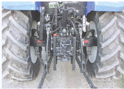
Les distributeurs hydrauliques sont désormais alignés. Les amortisseurs de la cabine ont été déplacés vers les bords extérieurs du véhicule.
