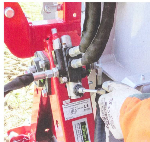
La commande de distributeur à l'arrière de la fagoteuse sert à déployer le vérin tendeur pour crocher la chaîne, puis exercer une tension de serrage de 2000 kg sur le ballot.
