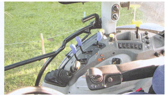
Les principaux éléments de commande sont regroupés latéralement sur le « Command Arc ». Le conducteur peut passer les vitesses avec le joystick de l'accoudeur.
