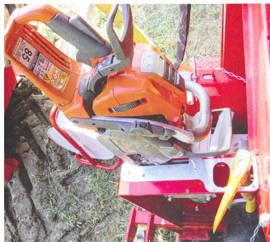
Détail pratique: les outils, comme la tronçonneuse ou une hache, peuvent être emmenés en toute sécurité sur la fendeuse.
