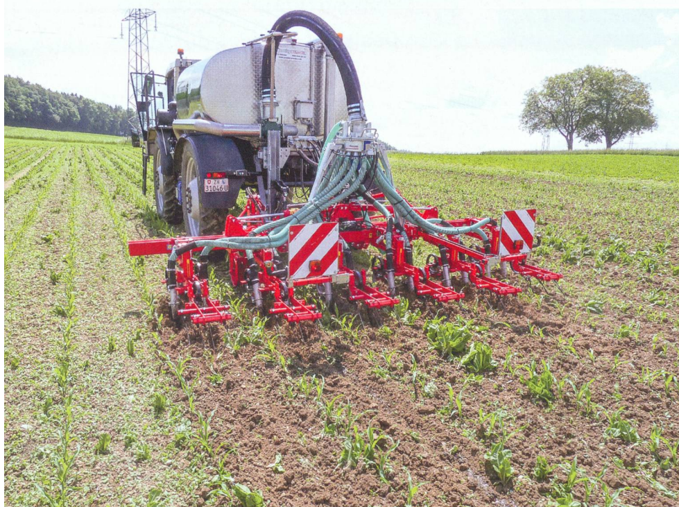
L'automoteur «Hydrotrac» pour l'incorporation de lisier dans le maïs avec sa cuve, sa tête de distribution et les tuyaux installés sur une sarceuse à six rangs. Photos: Roman Engeler et Peter Briner
