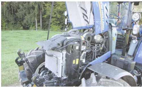
Le capot s'ouvre facilement. Il suffit de dévisser deux tôles pour accéder aux radiateurs des circuits d'huile et de refroidissement.
