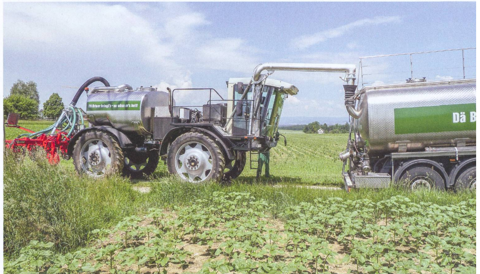
Le processus de remplissage de la cuve de 6 m 3 prend environ trois minutes.
