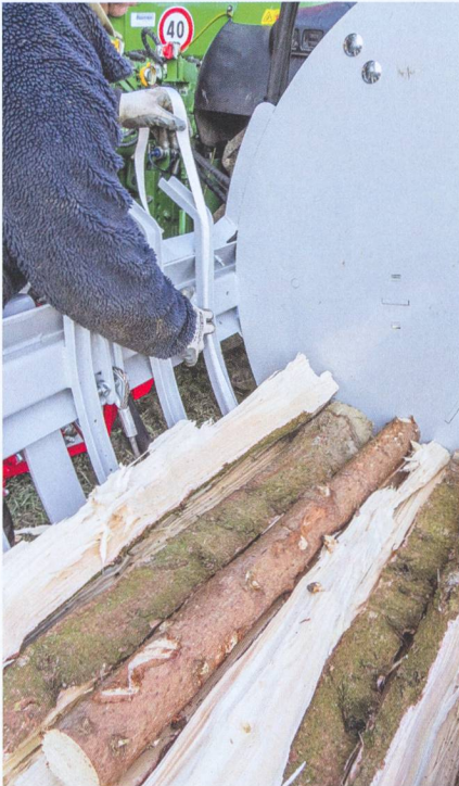
Le feillard en polyester doit être posé dans un des fers en «U» du panier avant d'y mettre du bois.
