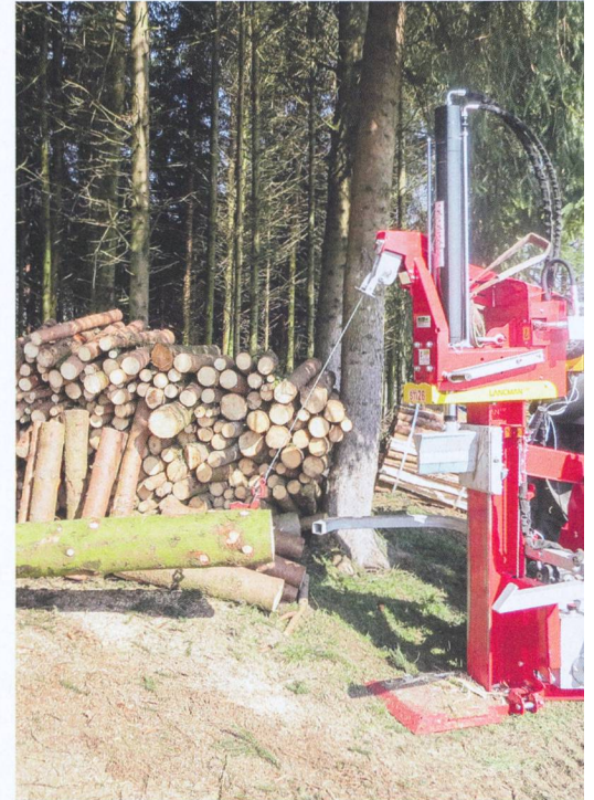
Le treuil permet d'approcher des bois sur une distance de 20 mètres.
