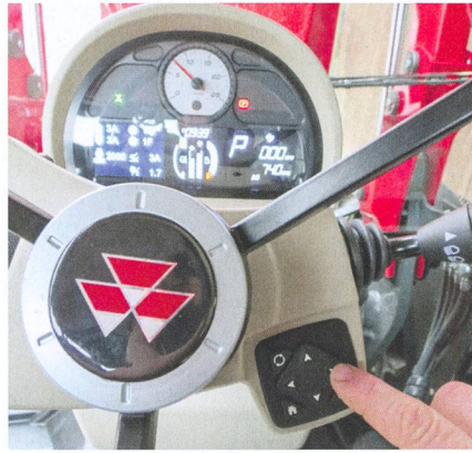
Le terminal « SIS » se commande en pressant les touches situées sous le volant à droite.
