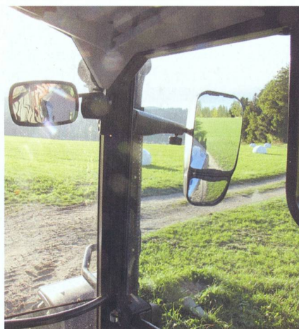
Les rétroviseurs en deux parties et à vision grand-angulaire offrent une vision sans angles morts vers l'arrière.
