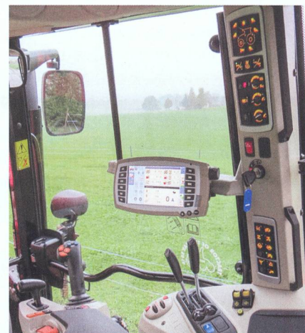
Placés sur le côté droit de la cabine et le montant « B », tous les éléments de commande disposent d'un accès ergonomique.
