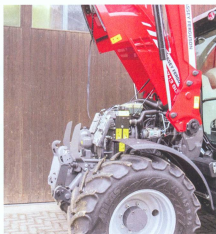
Le grand angle d'ouverture du capot permet un accès facile à tous les points d'entretien.
