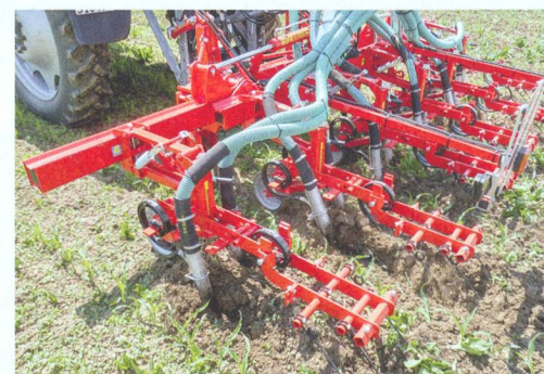
La sarceuse «Chopstar» d'Einböck avec les tubes en acier inoxydable ajoutés pour l'incorporation du lisier.
