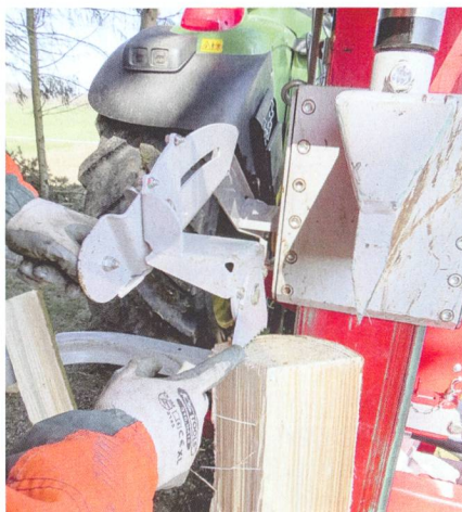
La fendeuse est dotée d'une griffe mobile pour positionner les bois.
