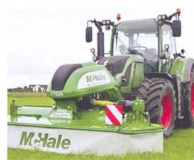
un mouvement pendulaire de +/- 17° est possible. En option, les deux faucheuses peuvent être équipées d'un conditionneur à doigts en acier.
