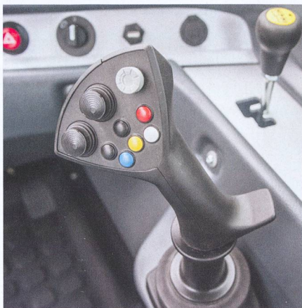
Le nouveau levier d'avancement permet la commande des principales fonctions avec une seule main.
