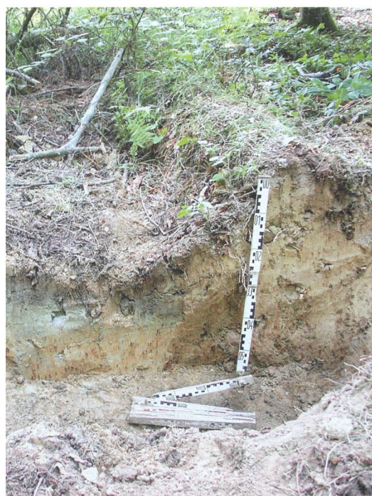
Ornière avec caractéristiques d'hydromorphie. Les couleurs de réduction (gris-bleu) et les taches couleur rouille indiquent une aération limitée du sol. Photo et légende: WSL
