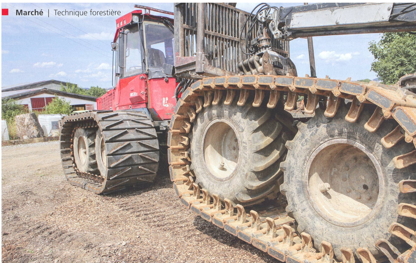
La semi-chenille «Marquardt» rigidifiée se compose de 36 maillons qui ont chacun un profil rectangulaire de 200×80 mm et une épaisseur de 8 mm. Photo: Bombosch, HAWK Göttingen (D)
