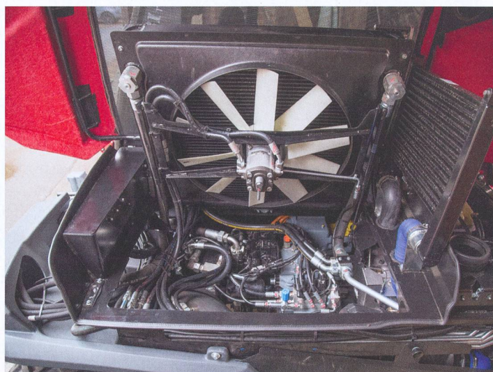
Aperçu du moteur avec le ventilateur qui peut être équipé en option de l'inversion des pales.
