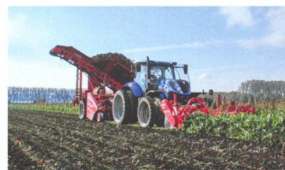
phase avec une arracheuse-chargeuse « Rootster 604 ». La « FT 300 » est munie d'un dispositif de dépose des feuilles qui empêche tout bourrage du rotor arrière. L'arracheuse traînée « Rootster » – 6-rangs aussi avec trémie de 4 tonnes – peut, quant à elle, être pilotée depuis le tracteur (puissance minimale requise de 185 chevaux) via un terminal informatique pour être utilisée en une phase ou bien en deux phases derrière l'effeuilleuse « BM 300 ».
