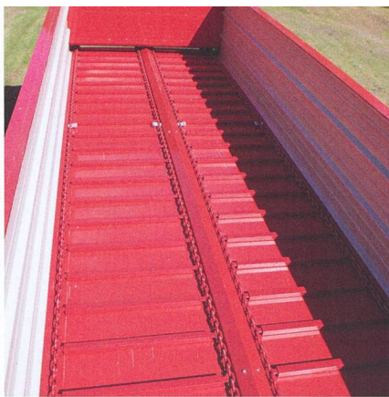
La remorque équipée d'un fond mouvant double a un temps de vidage de deux minutes et demie.
