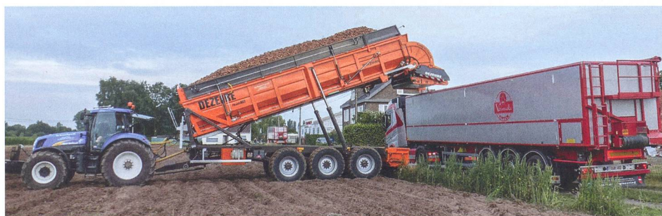
La remorque de transbordement « Turbo-Cleaner » de l'entreprise belge Dezeure sépare les tubercules des pommes de terre pendant le chargement des camions. Photo: deloonwerker.be
