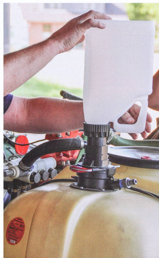
« EasyFlow », le système de transfert des produits phytosanitaires liquides, développé par Bayer et Agrotop, se voit décerner un PROFIL d'argent. Photo : Gaël Monnerat
