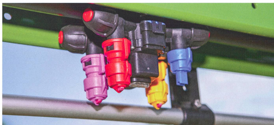
La fermeture électrique des buses de pulvérisation AmaSelect d'Amazone a séduit le jury qui lui attribue un PROFIL d'argent. Photo : Amazone
