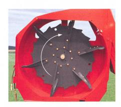
en col de cygne constituent les nouveautés. Selon la taille (2 à 6 m³), Vicon propose des machines portées ou tractées. Grâce au système spécial «DFCS», un peigne empêche les blocages du tambour en début de processus. La hacheuse de balles «Shredex» peut être utilisée pour le paillage et l'affouragement. www.kvernelandgroup.de
