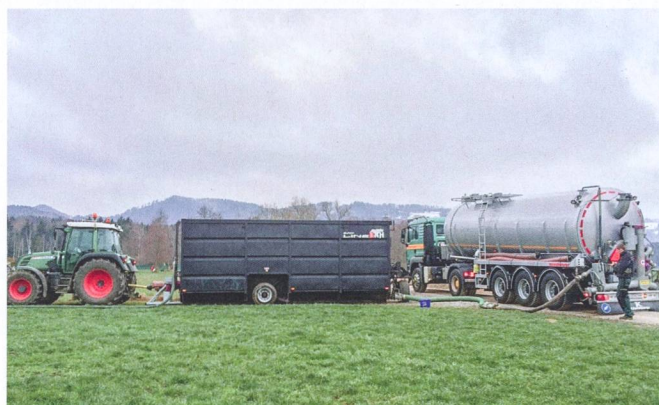
L'alimentation du pendillard nécessite un semi-remorque, un conteneur intermédiaire, un tracteur et une pompe d'alimentation.
